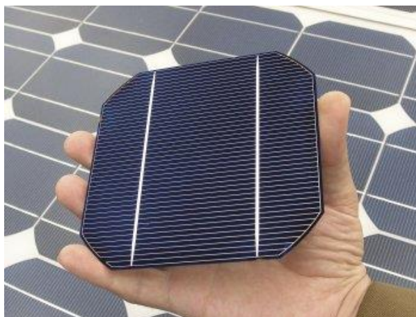
Obr. 3: FČ na bázi monokrystalického křemíku (zdroj: agrojournal.cz)
