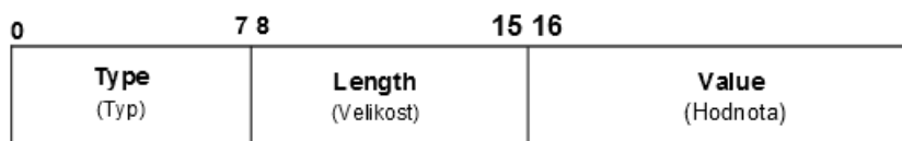
Obrázek 2.3: Formát těla paketu RADIUS: atributu ( attribute-value pairs )
