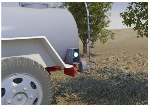
Obr. 28 Ultrazvukový senzor při aplikaci pesticidů
