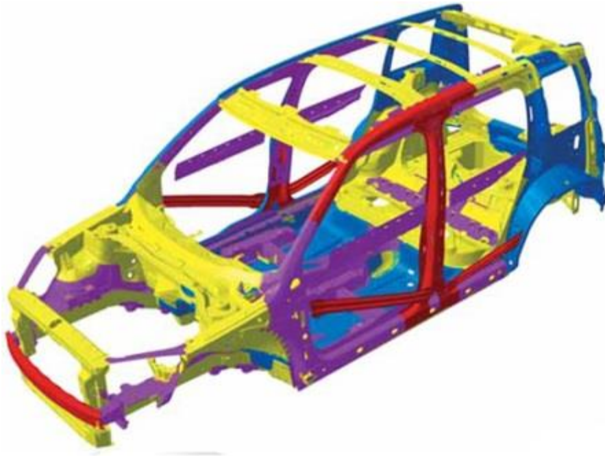
Obrázek 17 - Ukázka tuhosti karosérie a deformačních zón
