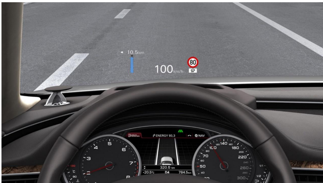
Obrázek 14 - Ukázka Head-up displaye
