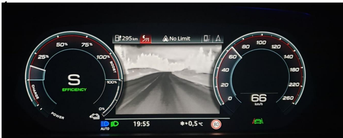
Obrázek 15 - Ukázka nočního vidění (Audi)
