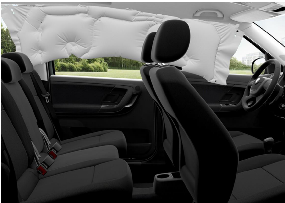
Obrázek 8 - Aktivní hlavový airbag
