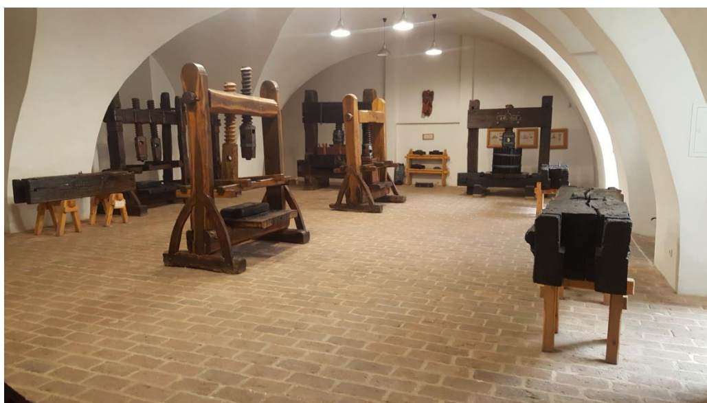
Obr. 1: Šroubový lis používaný pro výrobu vína – zámek Mikulov (Zdroj: fotoarchiv autora)
