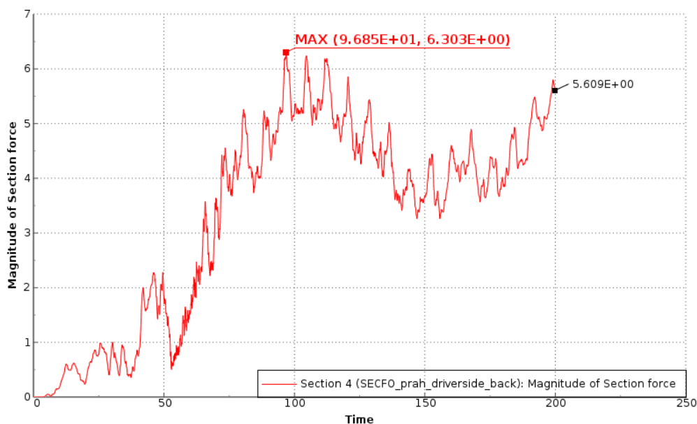
Obrázek 12.7: Závislost velikosti síly v zadní části prahu [kN] na čase [ms] u varianty s vyztuženými prahy
