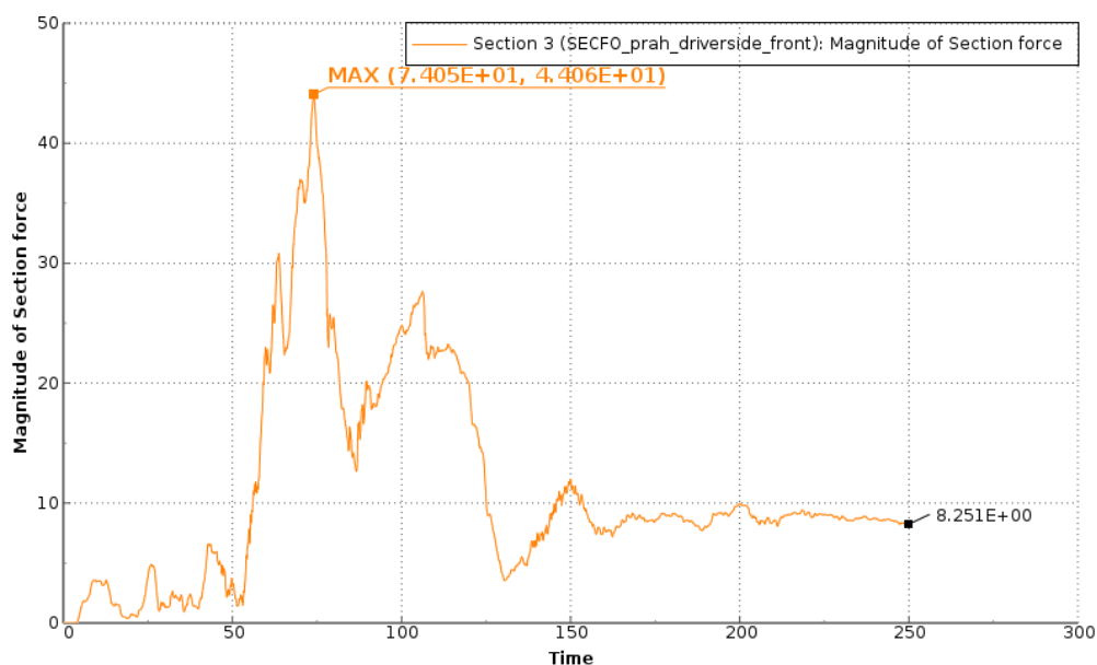
Obrázek 10.9: Závislost velikosti síly v přední části prahu [kN] na čase [ms] u varianty s výztuhou dveří v počáteční poloze
