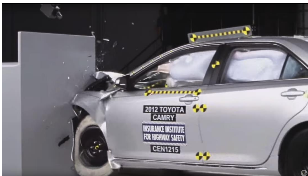
Obrázek 7.1: Začátek deformace předního kola v experimentu [14]
