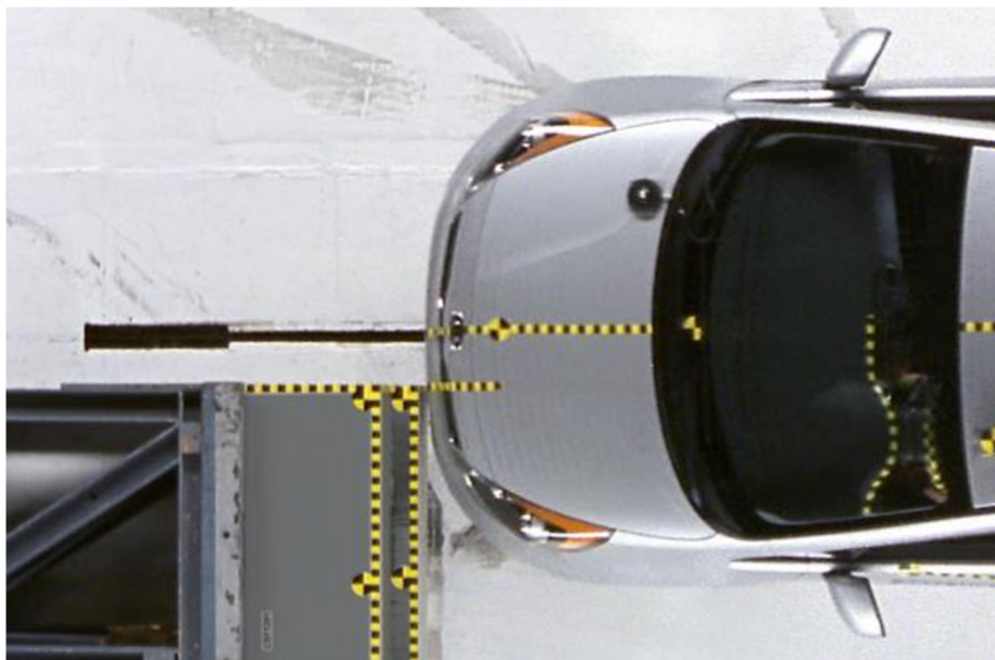
Obrázek 3.4: Náráz se 40% překrytím [4]
