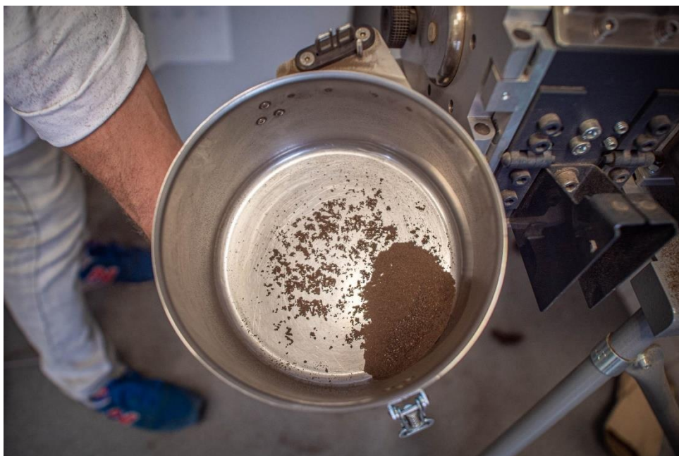
Obr. 13 rozemletá usušená biomasa
