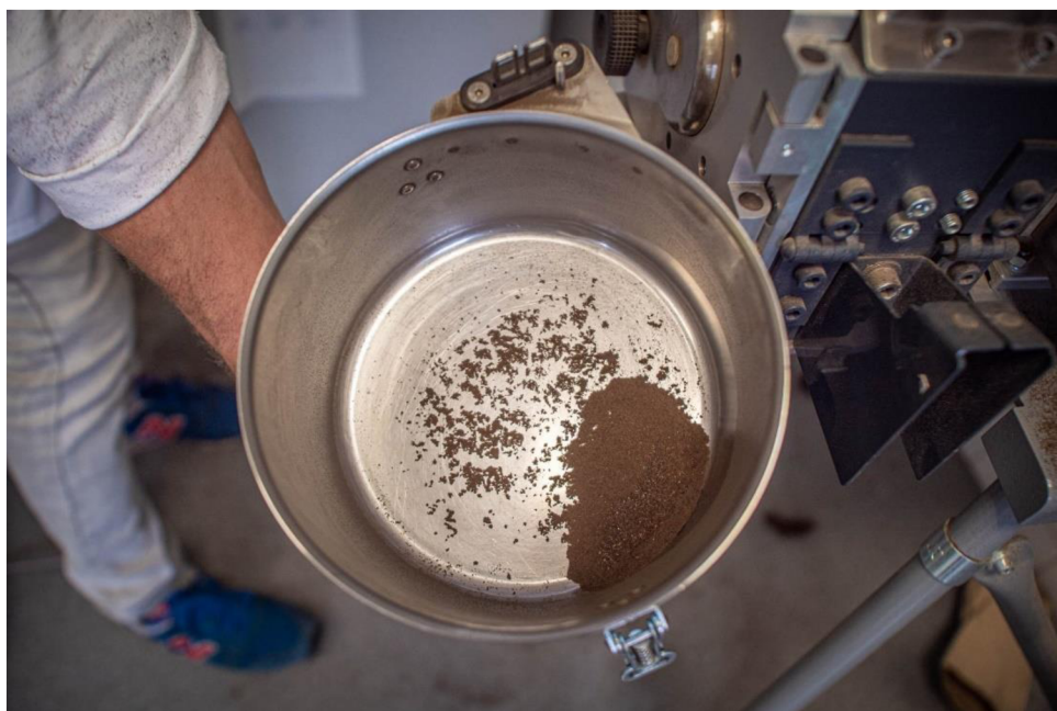
Obr. 13 rozemletá usušená biomasa
