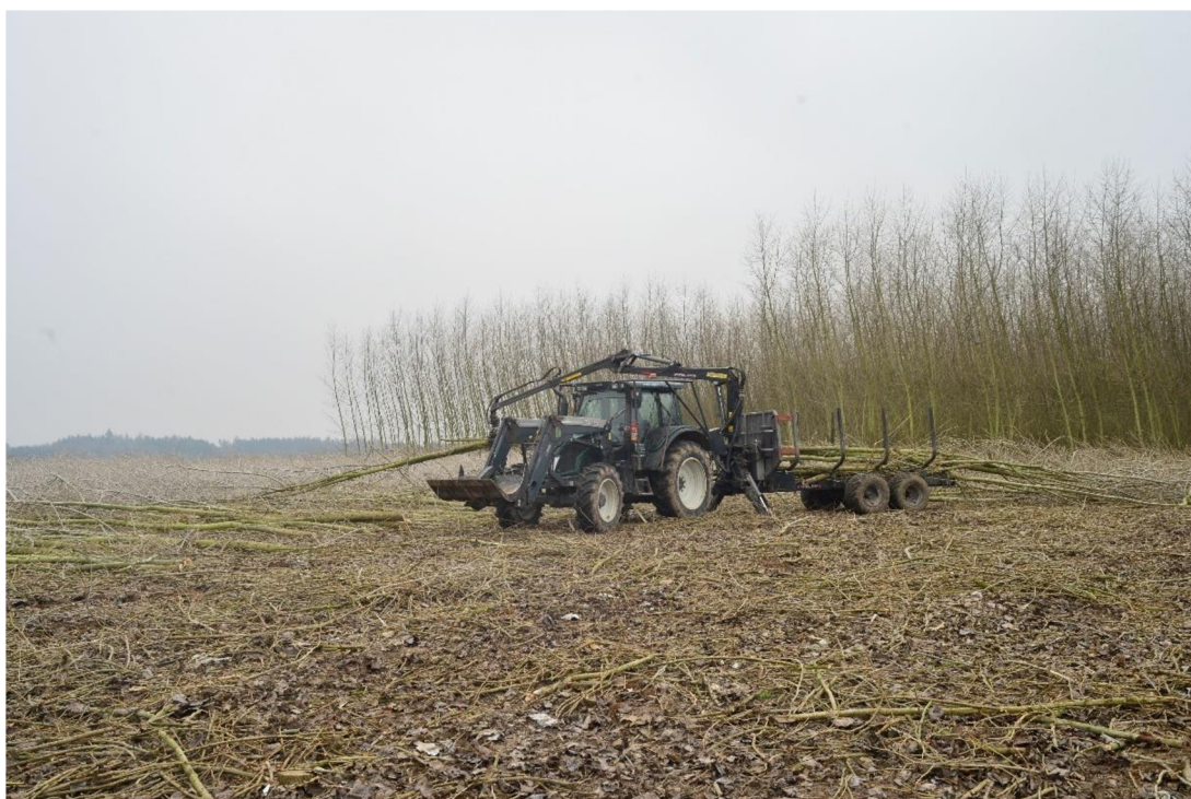
Obrázek 5: Vyvážecí traktor nakládající dřevní hmotu při sklizni plantáže RRD (foto autor)
