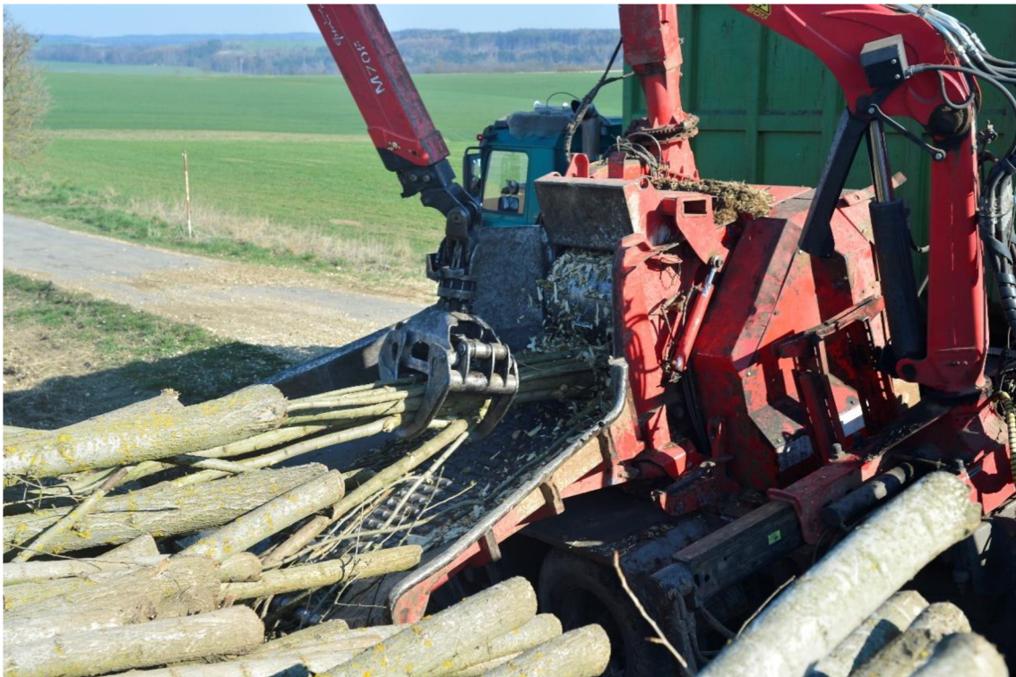
Obrázek 6: Štěpkování dřevní hmoty pomocí štěpkovače na odvozním místě a následné nakládání vzniklé štěpky na nákladní automobil (foto autor)
