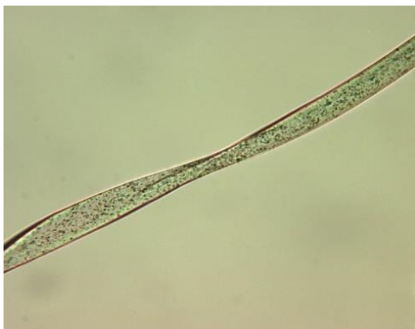
Obrázek 15: Polyesterové vlákno pod mikroskopem Převzato: [62]
