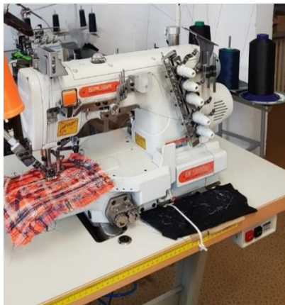
Obrázek 53: 3- jehlový ramenový šicí stroj se spodním a vrchním krytím
