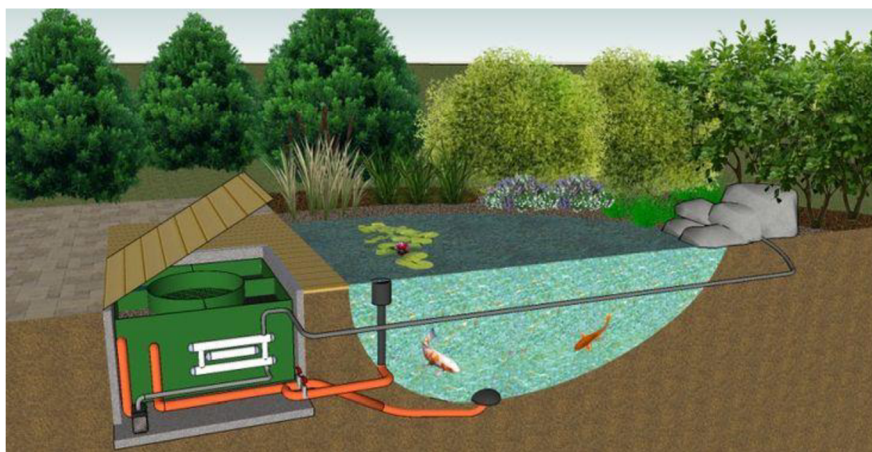
Obrázek 14: Gravitační filtrace (BANAT, 2003)
