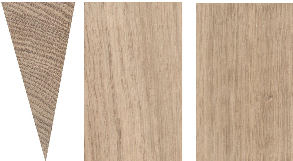
Obr. 1 Dub makroskopická stavba (příčný, radiální a tangenciální řez) (Vavřík a kol. 2002)
