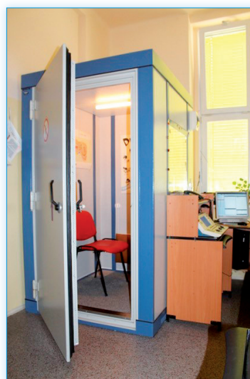
Obr. 2: Audiologická komora pro tónovou audiometrii
