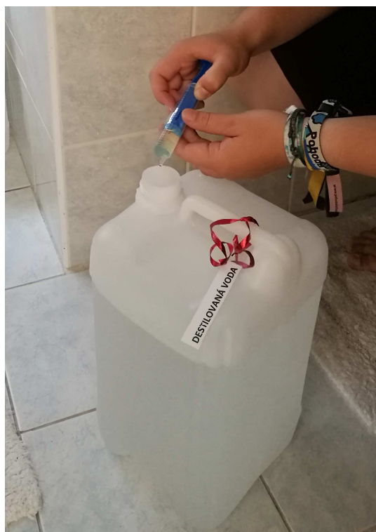
Obrázek 9 Dávkování chloru do destilované vody - vytvoření roztoku pro kontrolní vzorky
