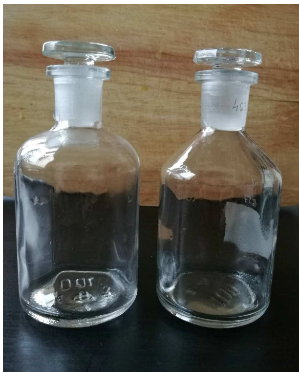
Obrázek 2 Porovnání tvaru reagenční lahve (vlevo) a kyslíkové lahve (vpravo)
