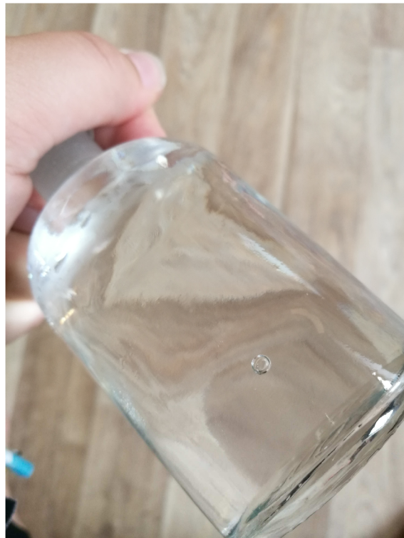
Obrázek 13 Vzduchová bublina vzniklá v reagenční lahvi
