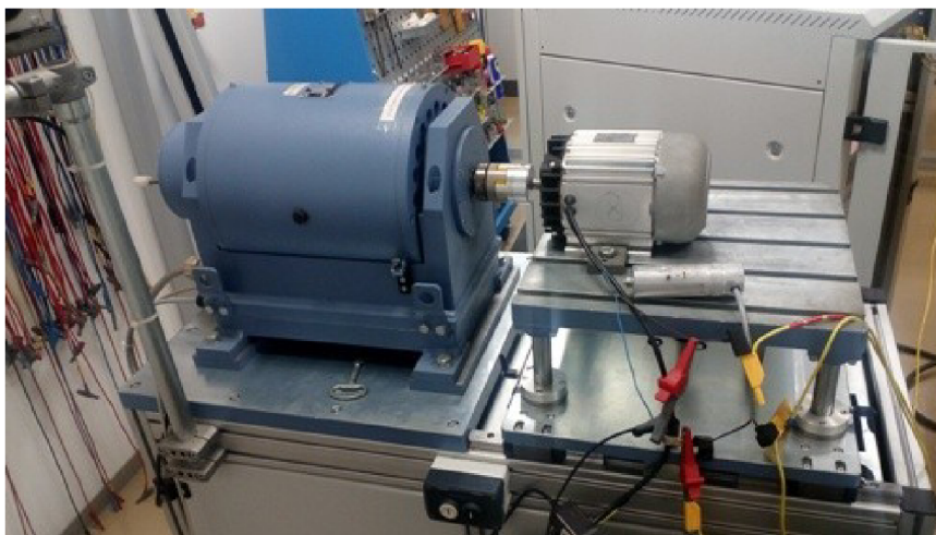
Obr. 22: Měřicí soustava - motor s připojeným kondenzátorem spojený s dynamometrem
