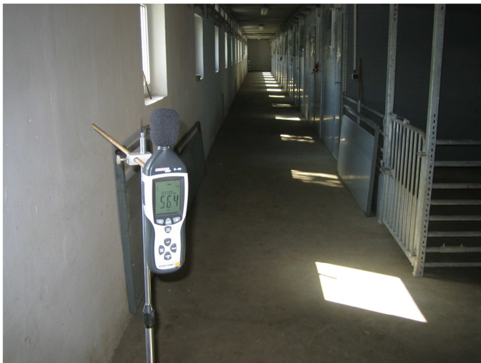
Obrázek 27 – Měření uvnitř budov pro březí prasnice a jalovice
