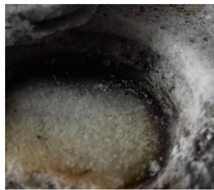
Obr. 72: Detail sedimentovaného plniva na dně otvoru, kde byla zakotvěná ocelová závitová tyč (EP-K + 60% OS)
