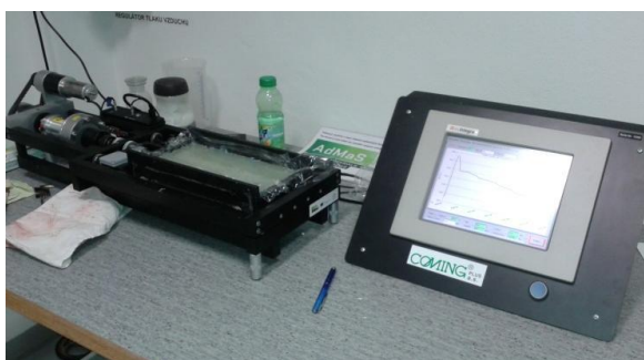
Obr. 48: Přístroj Tensograf TGF 02 pro stanovení smrštění vyvíjených sanačních hmot
