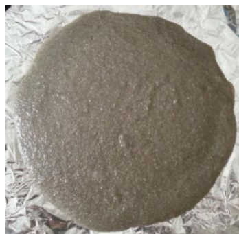
Obr. 76: Rozlití (EP-S + 75 % REF)
