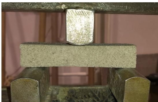
Obr. 50: Stanovení pevnosti v tahu za ohybu polymerní správkové hmoty s vysokým obsahem plniva
