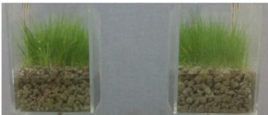
Obr. 41: Porézní vegetační polymerbeton tvořen z vysokopecní strusky, jutových vláken a styren butadienového latexu [68]
