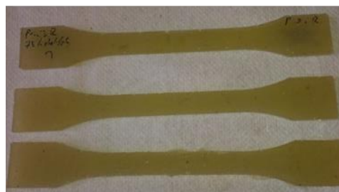
Obr. 55: Zkušební tělesa pro stanovení tahových vlastností od vyvíjené polymerní zálivkové hmoty
