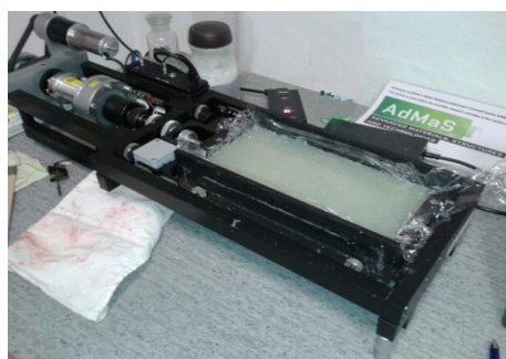
Obr. 49: Vyvíjená kotvící hmota s obsahem odpadního obalového skla při stanovování smrštění
