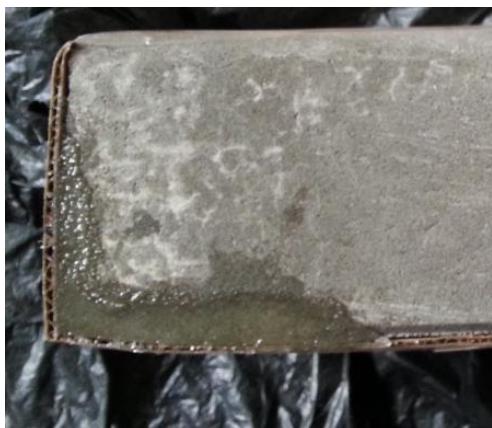
Obr. 123: Polymerizace hmoty EP-S 75% OS po aplikaci, při laboratorních podmínkách
