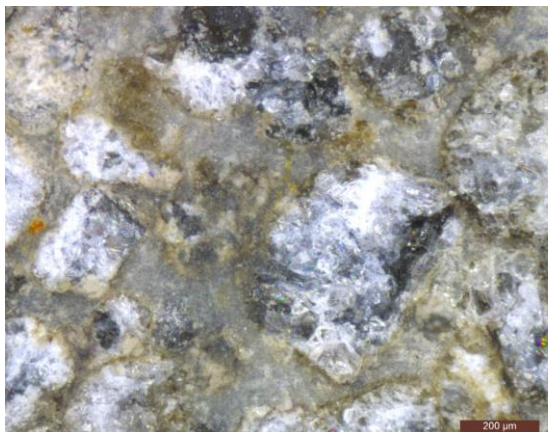
Obr. 136: Mikrostruktura správkové hmoty s 75% obsahem odpadního slévárenského písku (EP-S 75% SP) – zv. 100x
