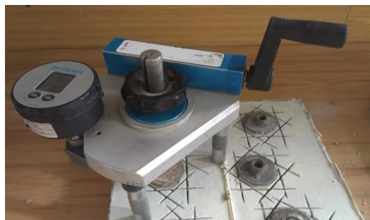
Obr. 53: Zkouška přídržnosti pomocí odtrhoměru DYNA Proceq
