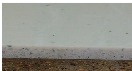
Obr. 67: Detail vytvrzeného vzorku EP-S + 75 % AS
