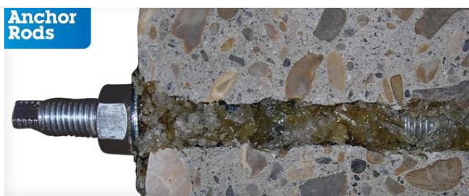
Obr. 18: Detail zakotvení ocelové závitové tyče pomocí chemické kotvy na bázi EP vysoce plněné křemičitým pískem [20]
