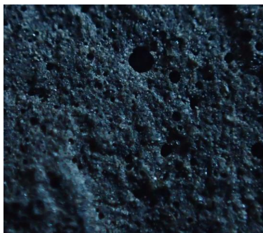
Obr. 132: Detail povrchu vyvinuté správkové hmoty EP-S 60% KP-TŘ – průřezová plocha vzorku po zkoušce pevnosti v tahu za ohybu (viditelné vzduchové póry a rovnoměrné rozložení částic plniva)
