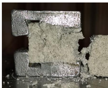
Obr. 90: Vzorek EP-S 85% REF po zkoušce pevnosti v tlaku.
