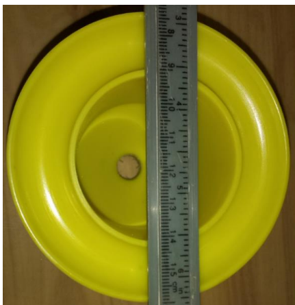
Obr. 44: Fordův výtokový kelímeček o průměru výtokové trysky 12 mm
