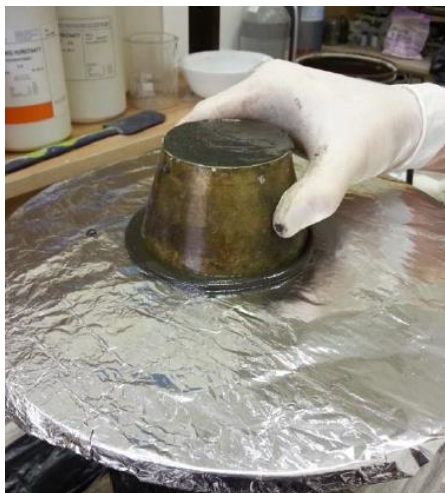
Obr. 46: Kužel naplněn správkovou hmotou s kontaminovaným popílkem
