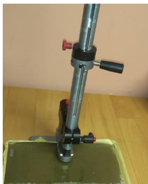
Obr. 58: Stanovování odolnosti vůči úderu vyvíjené polymerní správkové hmoty
