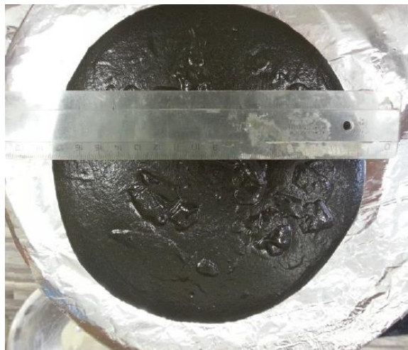
Obr. 47: Měření rozlivu vyvíjené správkové hmoty s obsahem popílku
