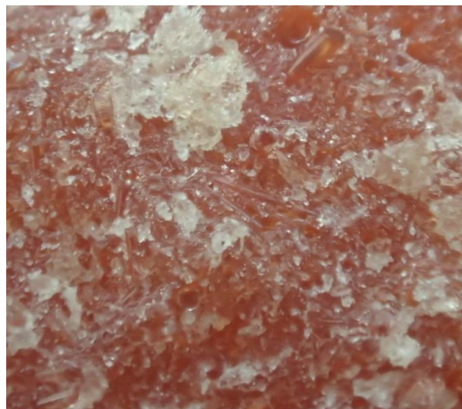
Obr. 130: Detail povrchu vyvinuté zálivkové hmoty EP-Z 65% OIDM – průřezová plocha vzorku po zkoušce pevnosti v tahu za ohybu (viditelné vzduchové póry a rovnoměrné rozložení částic plniva)
