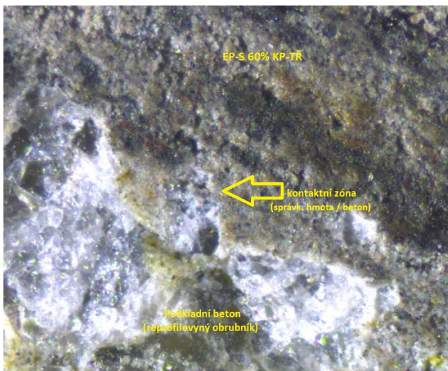
Obr. 140: Detail rozhraní správkové hmoty EP-S 60% KP-TŘ a podkladního betonu reprofilovaného obrubníku (zv. 100x)
