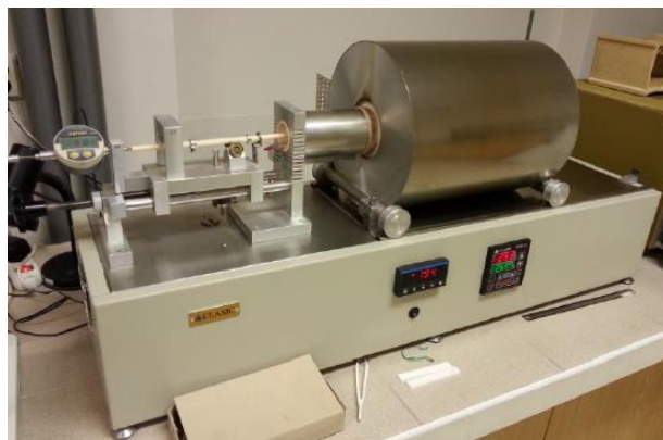
Obr. 63: Zařízení pro stanovení součinitele teplotní délkové roztažnosti \alpha
