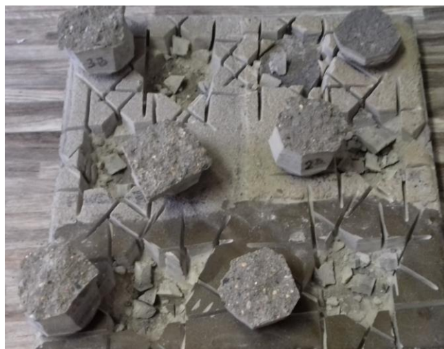
Obr. 120: Vzorky vybraných správkových hmot namáhány zmrazovacími cykly (T50) po zkoušce soudržnosti
