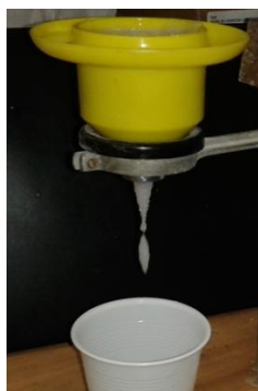
Obr. 73: Měření výtokové doby hmoty EP-S + 65% OS
