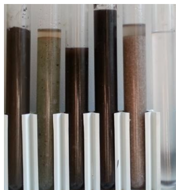
Obr. 70: Sedimentace plniva ve hmotě EP-S (zleva: 60% KP-TŘ, 75% AS, 80% SS, 80% SP, 75% REF, nepl.)
