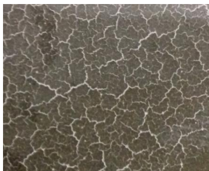
Obr. 118: Povrch vzorku EP-S 60% KP-TŘ po 50 zmrazovacích cyklech (T50)
