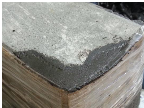
Obr. 124: Polymerizace hmoty EP-S 60% KP-TŘ po aplikaci, při laboratorních podmínkách
