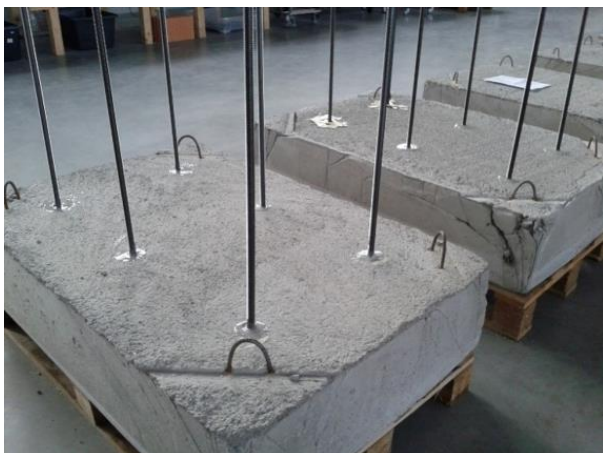
Obr. 59: Zakotvené závitové tyče připravené pro zkoušku vytržení
