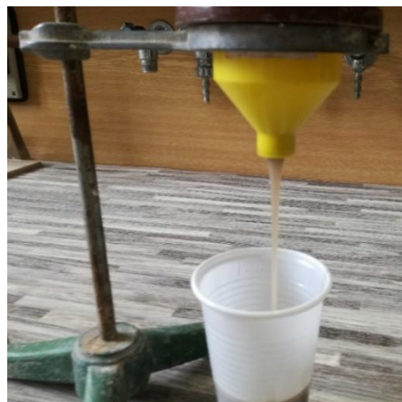
Obr. 45: Průběh stanovení viskozity pomocí Fordova výtokového kelímku
