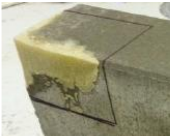
Obr. 171: Reprofilovaná část obrubníku (po působení povětrnostních vlivů), která byla vyříznuta a následně snímaná pomocí CT Tomografie (hmota EP-S 75% OS)
