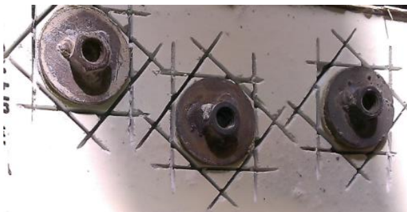
Obr. 52: Ořezané terče připravené pro zkoušku soudržnosti s betonovou dlažbou – správková hmota s odpadním sklem
