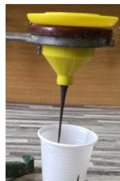
Obr. 74: Měření výtokové doby hmoty EP-K + 45% KP-NOV
