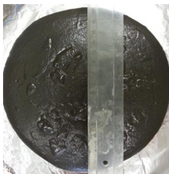
Obr. 75: Měření rozlití (EP-S + 60% KP-TŘ)
