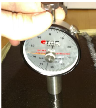
Obr. 56: Stanovení tvrdosti Shore D ( H_D ) polymerní správkové hmoty
