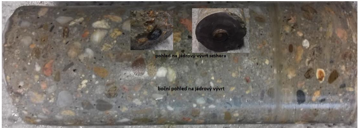
Obr. 182: Jádrový vývrt ( \varnothing 75 mm) pro CT snímání kvality zakotvení ocelové závitové tyče
