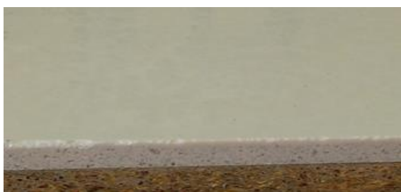
Obr. 66: Detail vytvrzeného vzorku EP-S + 75 % OS
