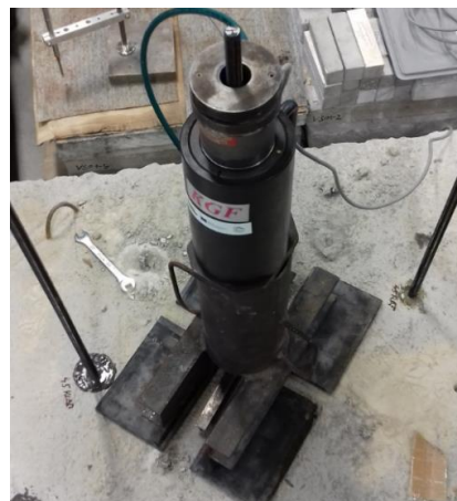
Obr. 60: Vytrhávací zařízení od společnosti KGF
