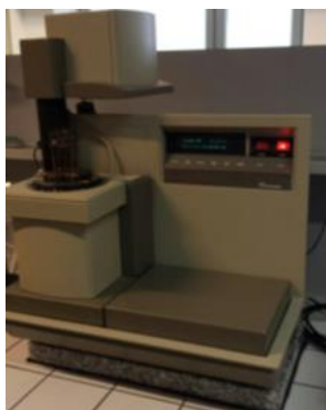
Obr. 61: Zařízení DMA 2980 (TA Instruments) pro stanovení T_g
