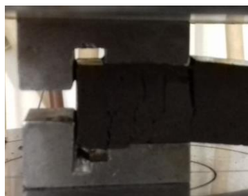
Obr. 91: Vzorek EP-S 60% KP-TŘ po zkoušce pevnosti v tlaku.
