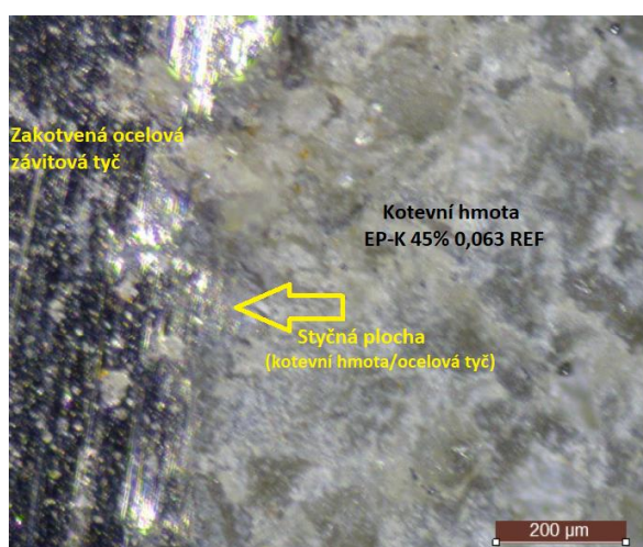
Obr. 146: Detail rozhraní ocelové závitové tyče kotvené kotvící hmotou EP-K 45% 0,063 REF (zv. 100x)
