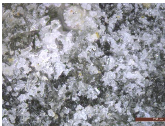
Obr. 139: Mikrostruktura záливkové hmoty EP-Z 65% OIDM – zv. 200x
