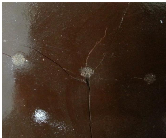
Obr. 96: Výrazná síť trhlin způsobená dopadem úderníku (EKO-X 40% NK)
