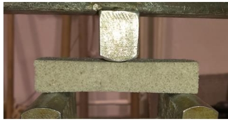
Obr. 83: Stanovování třibodové pevnosti v tahu za ohybu (EP-S+80% REF)
