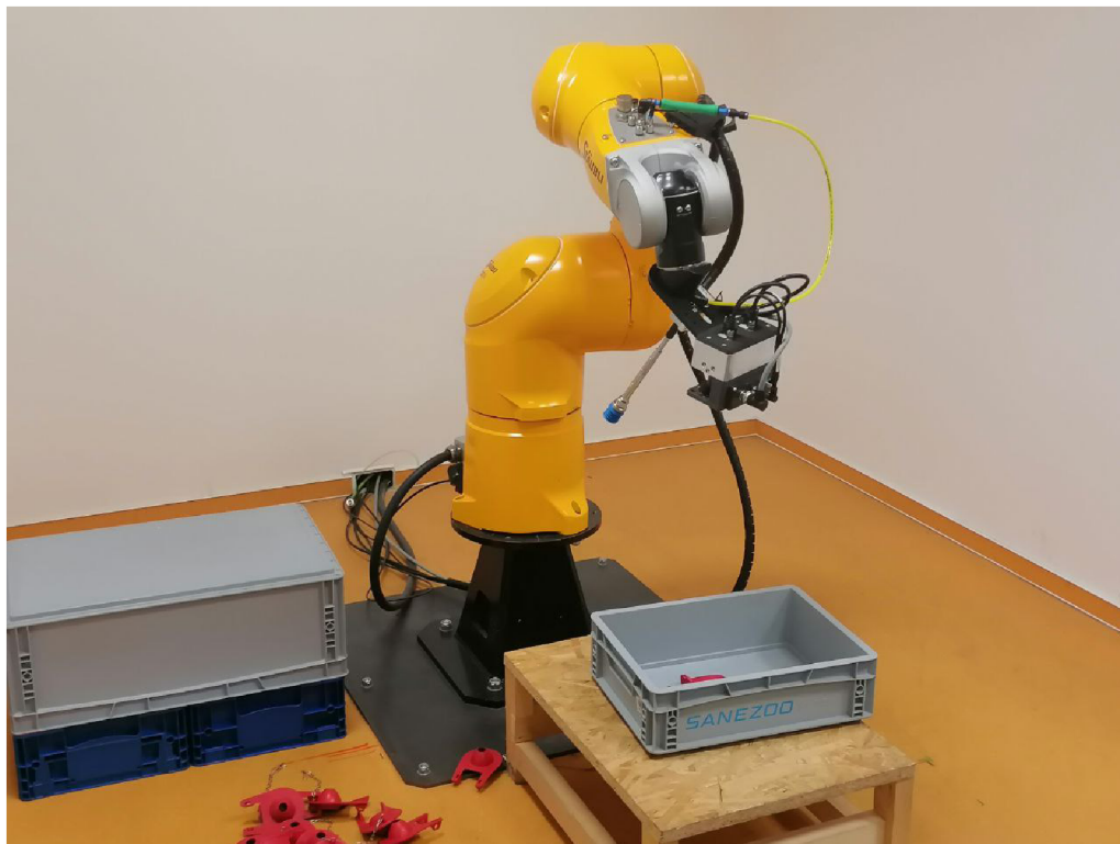
Obrázek 2.1: Robot pro kontrolu kvality
