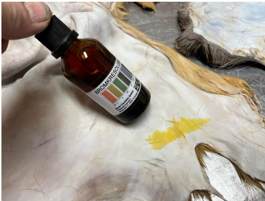
Obrázek 12 - měření pH pomocí bromkresol zeleně, foto autora
