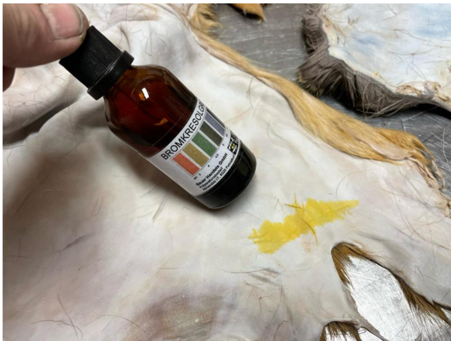
Obrázek 12 - měření pH pomocí bromkresol zeleně, foto autora
