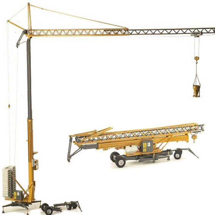
Obr. 24: Věžový jeřáb Liebherr 32TT
