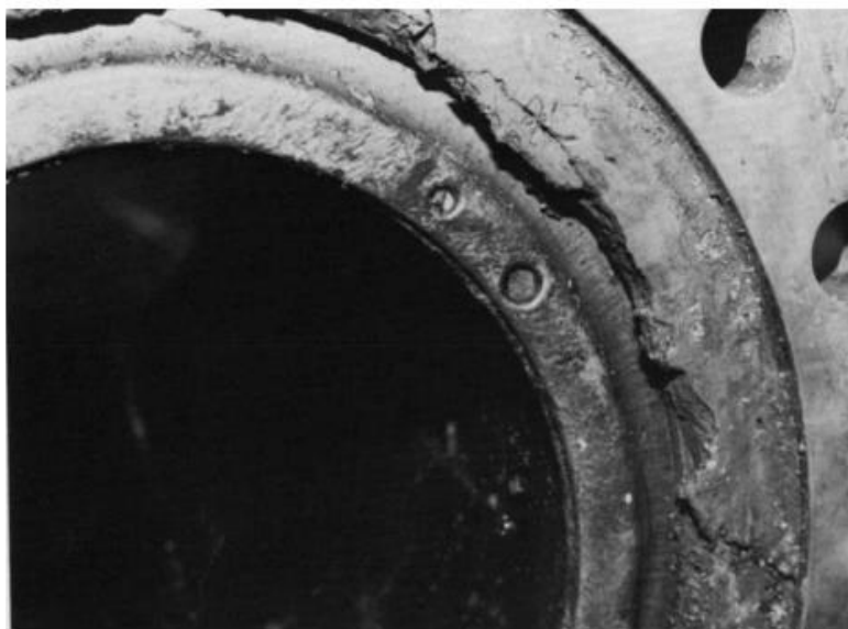
Obr. 14 Nahromadění nečistot zubové spojky[21]
