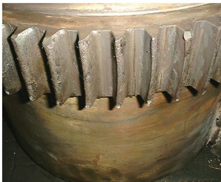
Obr. 15 Poškození zubové spojky nadměrném vychýlení spojky[21]
