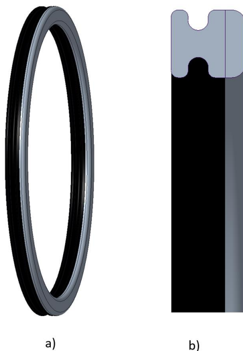
Obr. 23 Pryžový doraz a) v obecném pohledu b) v řezu
