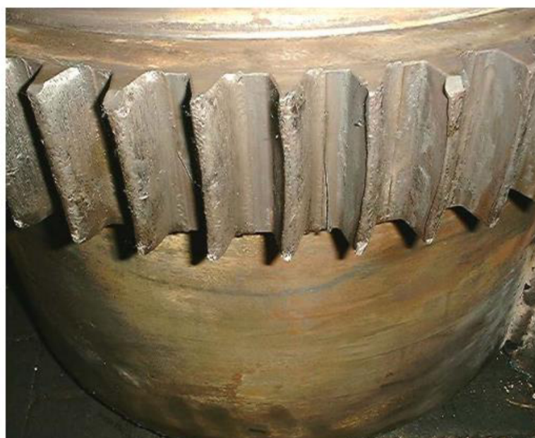
Obr. 15 Poškození zubové spojky nadměrném vychýlení spojky[21]
