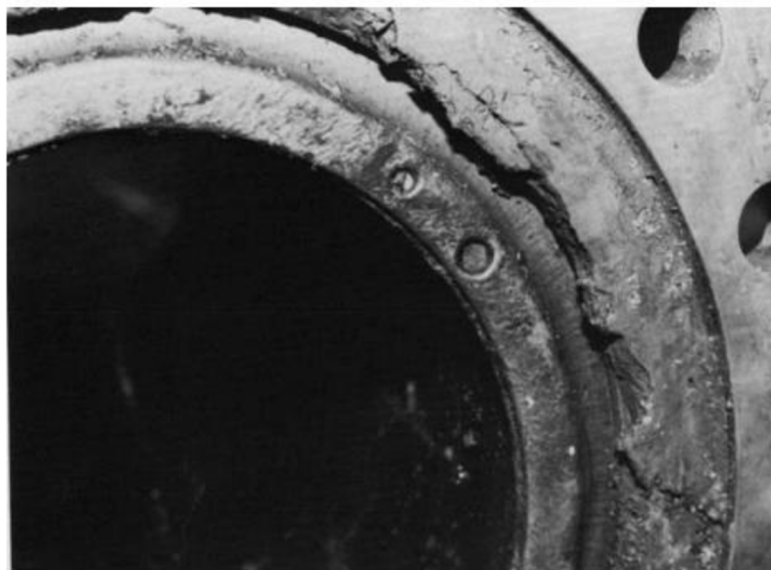
Obr. 14 Nahromadění nečistot zubové spojky[21]
