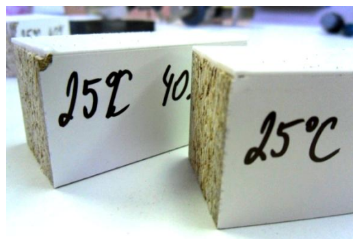
Obr. 77 a 78: Poškození vzorků po zkoušce šikmý tlakový smyk pod úhlem 45°
