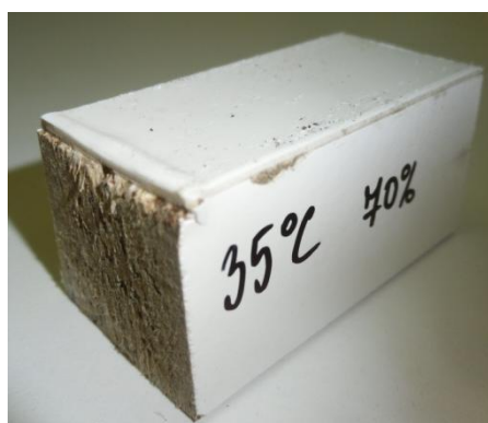
Obr. 79 a 80: Poškození vzorků po zkoušce šikmý tlakový smyk pod úhlem 45°
