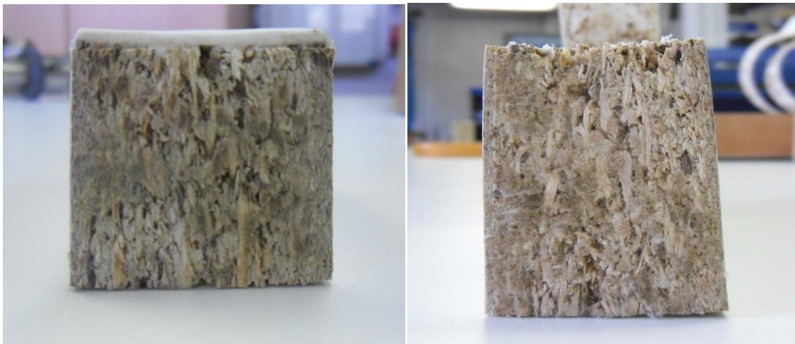
Obr. 74 a 75: Nabobtnání vzorků po působení zvýšené vlhkosti po dobu 6 týdnů
