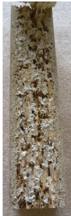
Obr. 98 a 99: Poškození vzorků po zkoušce odlup pod úhlem 90°
