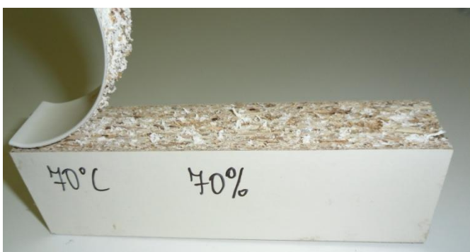
Obr. 96 a 97: Poškození vzorků po zkoušce odlup pod úhlem 90°
