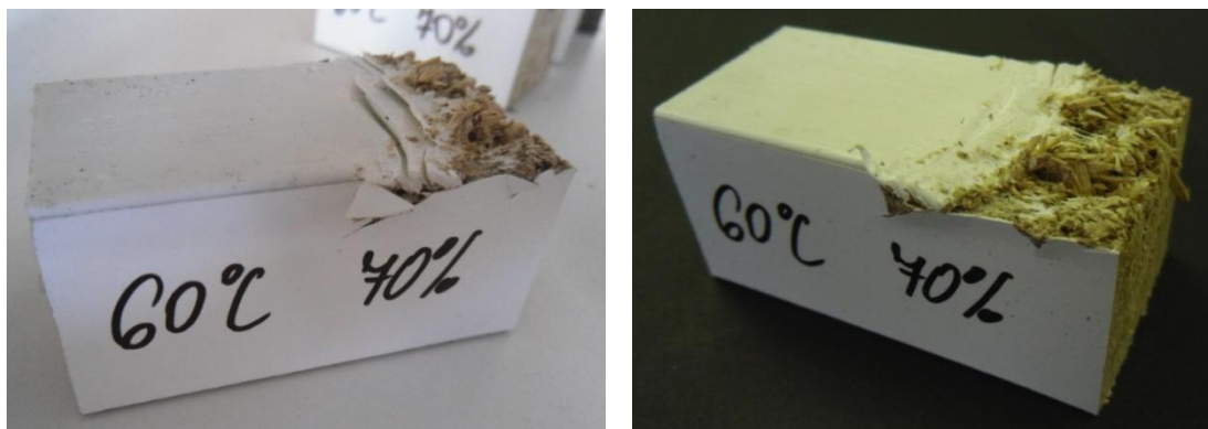
Obr. 83 a 84: Poškození vzorků po zkoušce šikmý tlakový smyk pod úhlem 45°
