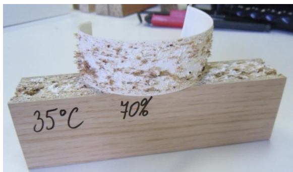
Obr. 90 a 91: Poškození vzorků po zkoušce odlup pod úhlem 90°
