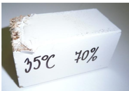
Obr. 79 a 80: Poškození vzorků po zkoušce šikmý tlakový smyk pod úhlem 45°
