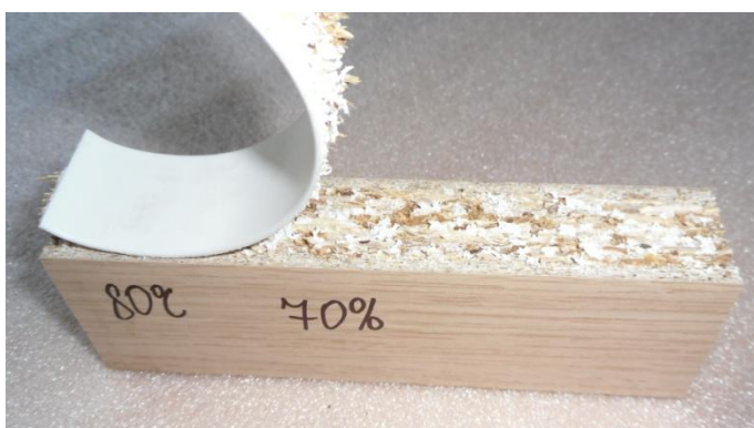
Obr. 98 a 99: Poškození vzorků po zkoušce odlup pod úhlem 90°
