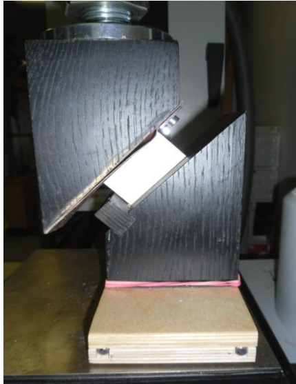
Obr. 32, 33: Umístění vzorku do speciálního agregátu, zdokumentování vzorku po zkoušce (zdroj: autor)
