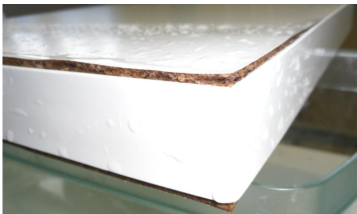
Obr. 58: Změna na vzorku DTD-L olepeného pomocí tavného EVA lepidla po 8 hodinách máčení ve vodě (zdroj: autor)
