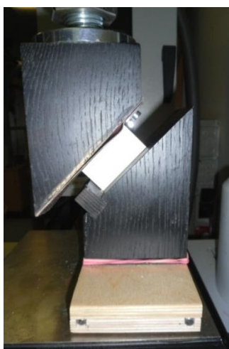
Obr. 15: Speciální agregát pro zkoušku šikmý smyk (zdroj: autor)
