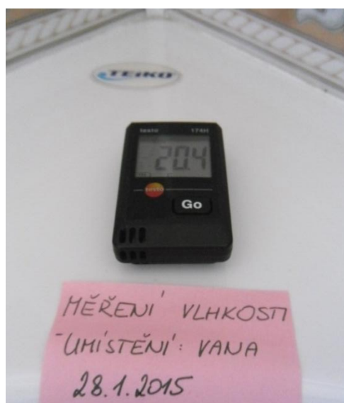
Obr. 26, 27: Měření vlhkosti a teploty v prostoru koupelny pomocí dataloggeru (zdroj: autor)
