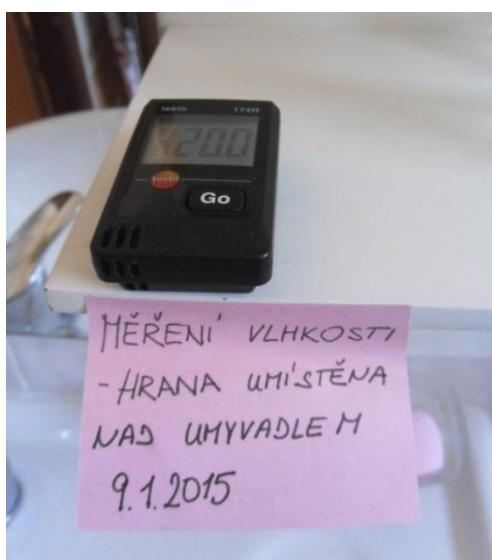
Obr. 26, 27: Měření vlhkosti a teploty v prostoru koupelny pomocí dataloggeru (zdroj: autor)
