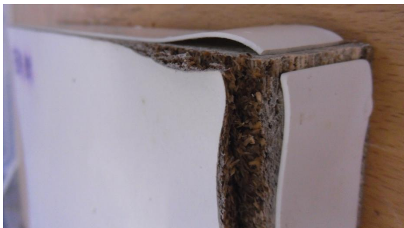
Obr. 55: Působení extrémních podmínek po dobu 8 hodin a deformace vzniklé na DTD olepené EVA tavným lepidlem (zdroj: autor)
