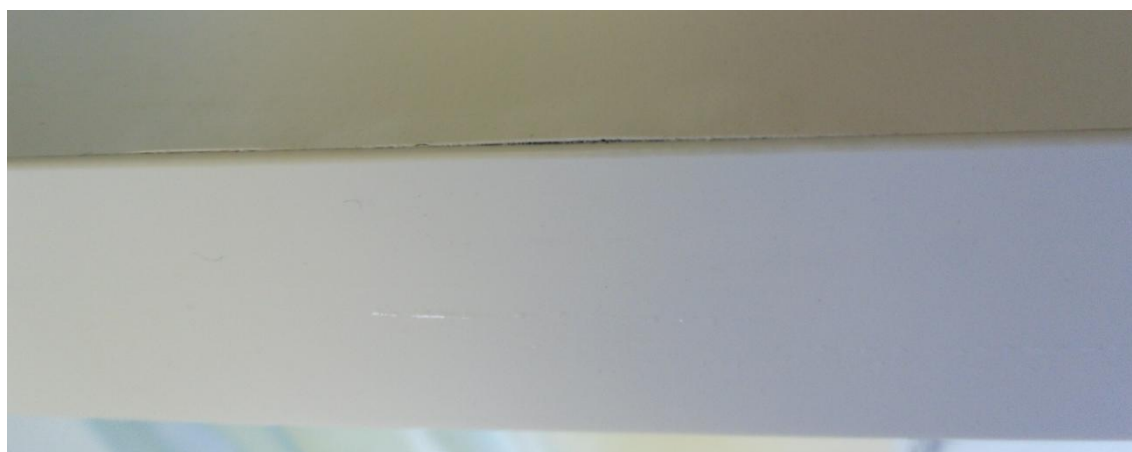
Obr. 71: Nabobtnání DTD-L s využitím tavného PUR lepidla v oblasti mikrotrhliny po působení vody po dobu 8 hodin (zdroj: autor)
