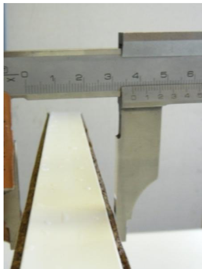
Obr. 69: Rozměrová změna na DTD-L s využitím tavného EVA lepidla po 8 hodinách máčení ve vodě (zdroj: autor)
