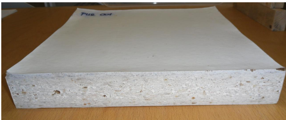
Obr. 65: Vzorek s využitím tavného PUR lepidla po ukončení zkoušky (zdroj: autor)
