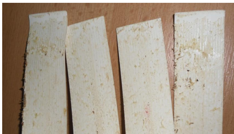
Obr. 64: ABS hrany se stopami EVA tavného lepidla a třískami uvolněnými z DTD-L po ukončení zkoušky (zdroj: autor)
