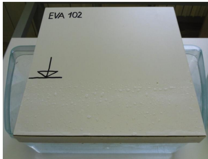
Obr. 68: Vzorek DTD-L olepen pomocí tavného EVA lepidla po vyjmutí z akvária s vodou (zdroj: autor)
