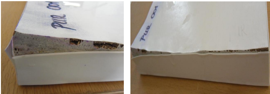
Obr. 53, 54: Působení extrémních podmínek po dobu 4 hodin a deformace vzniklé na DTD olepené PUR tavným lepidlem (zdroj: autor)
