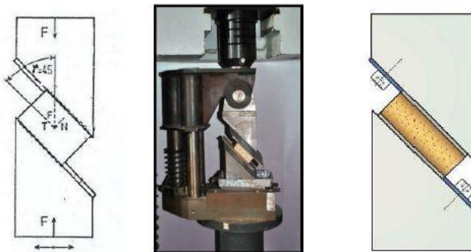
Obr. 40: Šikmý tlakový smyk pod úhlem 45° (Dubovský, J. 1990)
