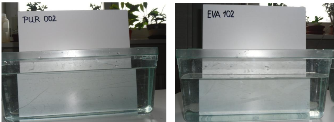
Obr. 36, 37: Vzorky ponořené do vody na dobu 8 hodin (zdroj: autor)
