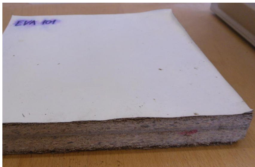
Obr. 63: Vzorek s využitím tavného EVA lepidla po ukončení zkoušky (zdroj: autor)
