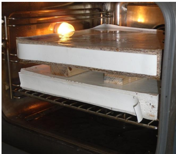
Obr. 57: Změny na olepěných DTD deskách po 11 hodinách a 30 minutách působení extrémních podmínek (vrchní deska olepěna pomocí tavného EVA lepidla, spodní deska olepěna pomocí tavného PUR lepidla) (zdroj: autor)
