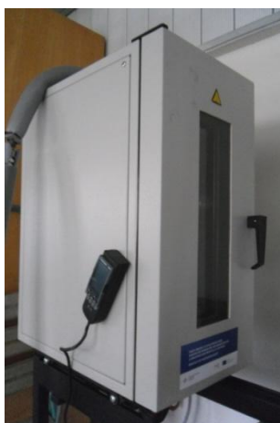
Obr. 16: Tepelná komora INSTRON (zdroj: autor)
