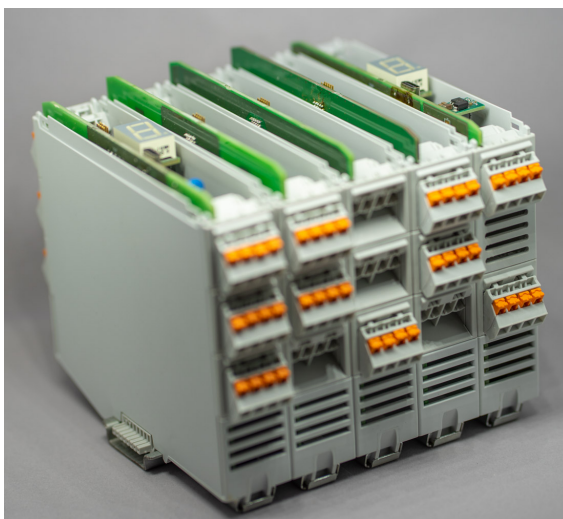
Obr. 13.3: Modulární řídicí systém umístěný v krabičkách na DIN liště.
