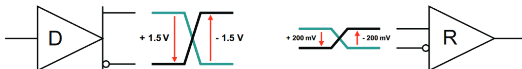
Obr. 2.1: Znázornění realizace driveru pro RS-485[19].
