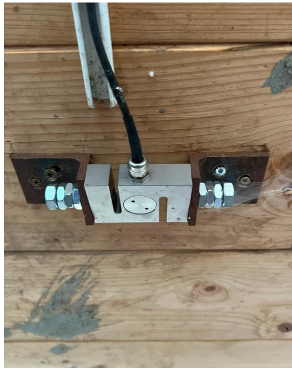
Obr. 52 - strunový tenzometr (Ahlborn almemo FKA0255) na spodním líci konstrukce
