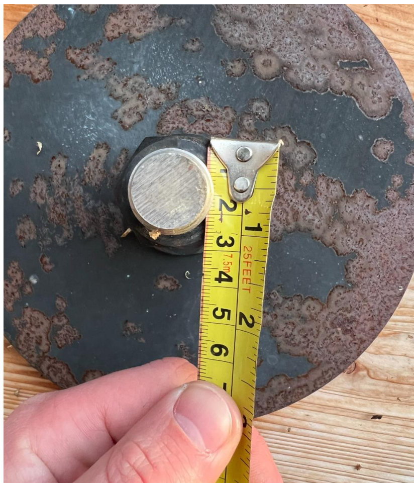
Obr. 42 - spojovací prostředky vykazují známky reznutí.
