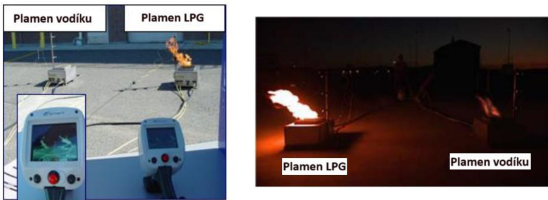
Obrázek 22: Plameny vodíku a LPG na denním světle a v noci [51], upraveno
