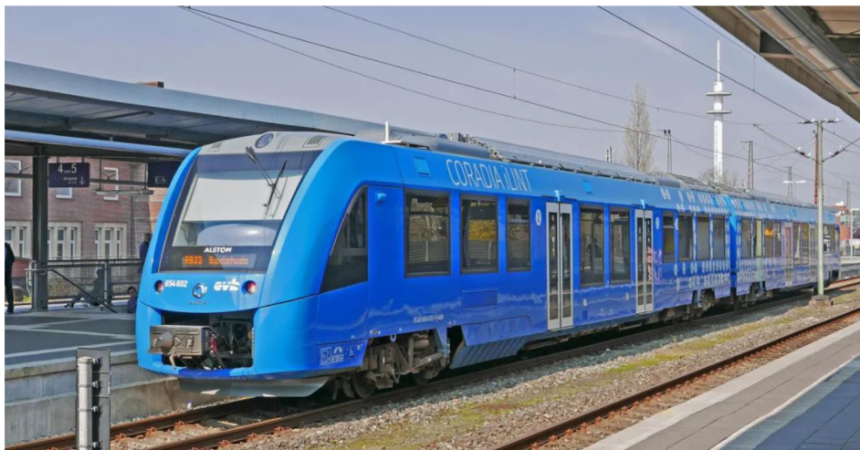
Obrázek 12: Německá vlaková souprava na vodíkový pohon [20]
