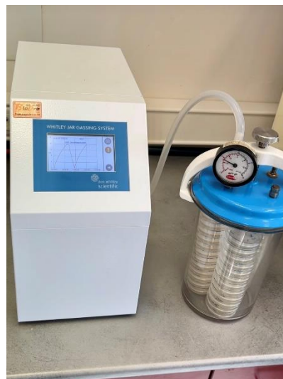
Obrázek 12: Whitley jar gassing system
