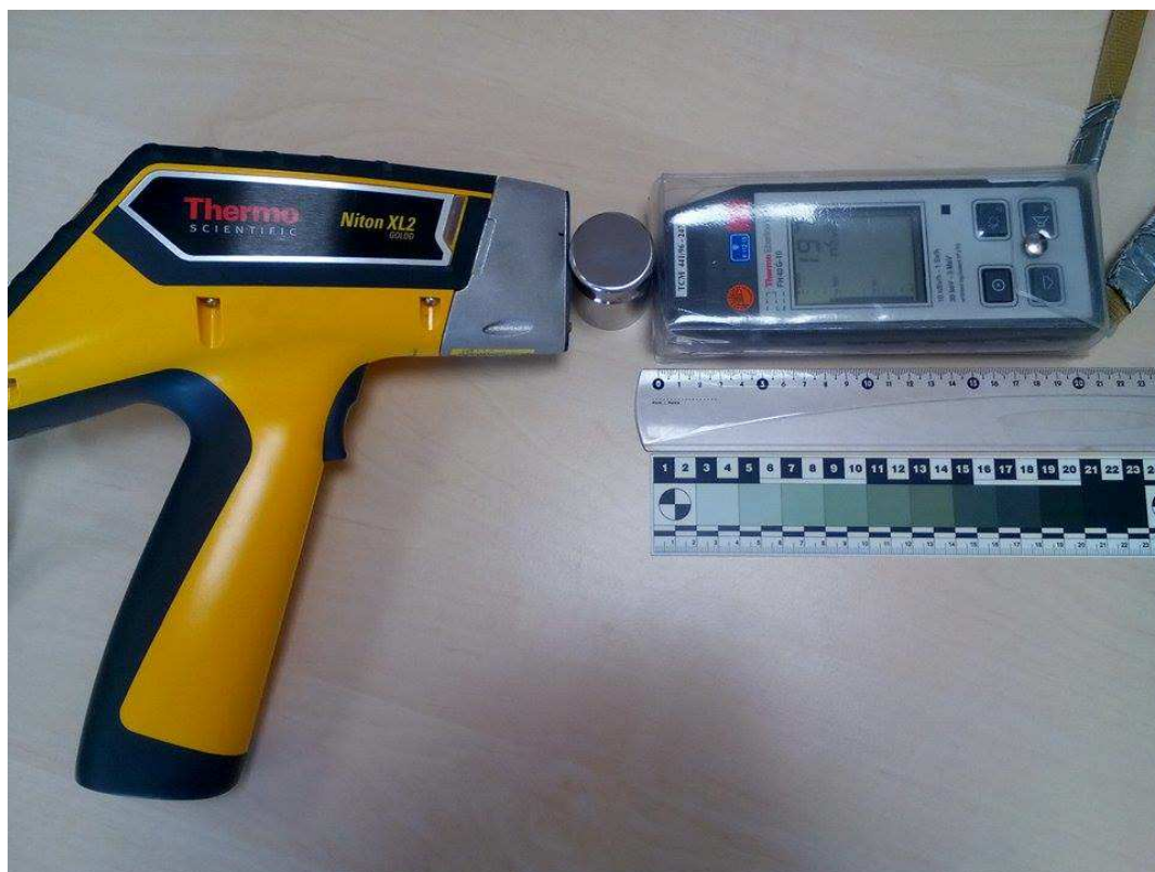
Obrázek 6: Měření dávkového příkonu přístrojem FH 40G-10 (vlastní zpracování)
