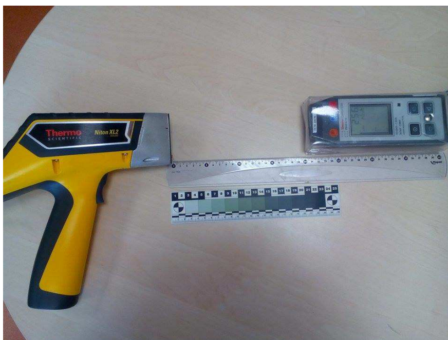
Obrázek 10: Vzdálenost měřiče od spektrometru 30 cm (vlastní zpracování)
