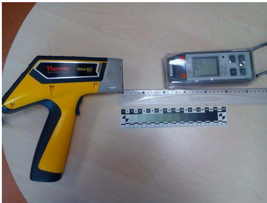
Obrázek 9: Vzdálenost měřiče od spektrometru 10 cm (vlastní zpracování)
