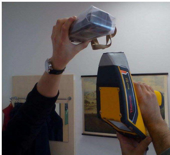
Obrázek 8: Měření mince, která leží na mobilním analyzátoru (vlastní zpracování)
