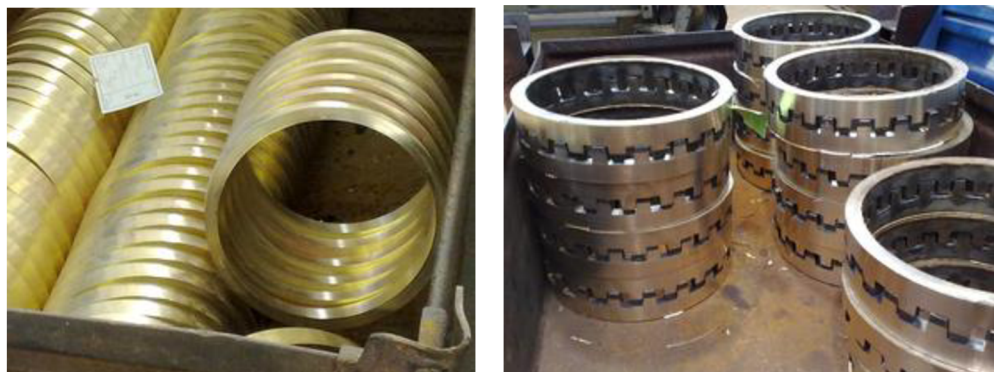
Obr. 2.7 Polotovary pro výrobu mosazných klecí. Vlevo mosazná trubka, vpravo mosazné výkovky.
