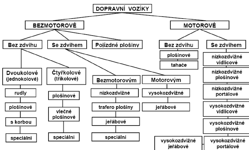
Obr. 1.12 Schéma rozdělení dopravních vozíků. 4
