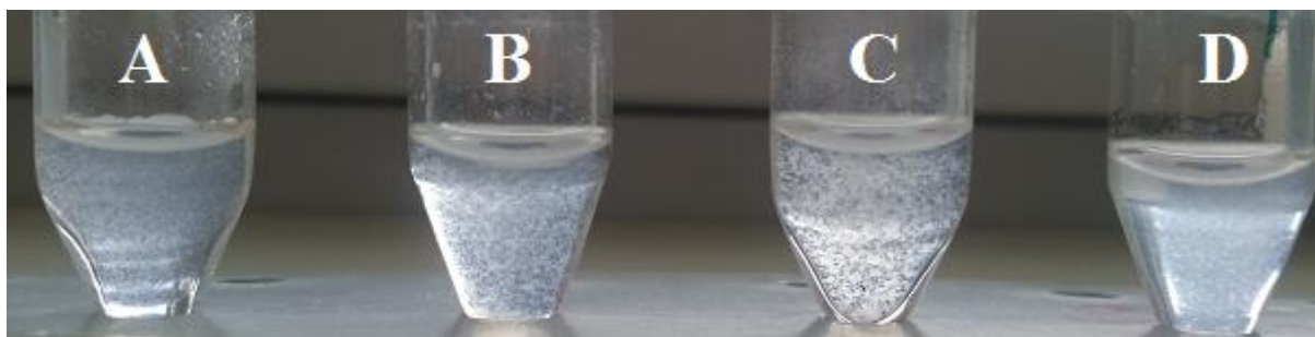
Obrázek 38: Fotografie systémů polystyrensulfoát-lipid s různým hmotnostním poměrem DPTAP/polystyrensulfoát. A) poměr 3,9 – PSS 41 \text{ mg} \cdot \text{dm}^{-3} , B) poměr 3 – PSS 54 \text{ mg} \cdot \text{dm}^{-3} , C) poměr 2 – PSS 80 \text{ mg} \cdot \text{dm}^{-3} , D) poměr 1 – PSS 160 \text{ mg} \cdot \text{dm}^{-3} .
