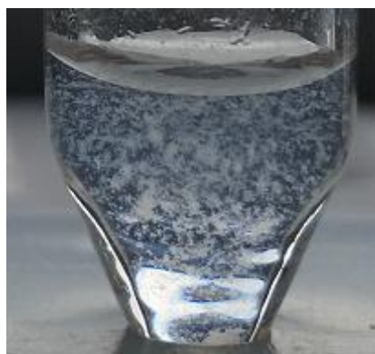
Obrázek 24: Fotografie fázově separovaného systému chondroitin sulfát-lipid s poměrem 3,2 (CS 50 \text{ mg} \cdot \text{dm}^{-3} ) hmotnostní koncentrace lipidu DPTAP a chondroitin sulfátu.
