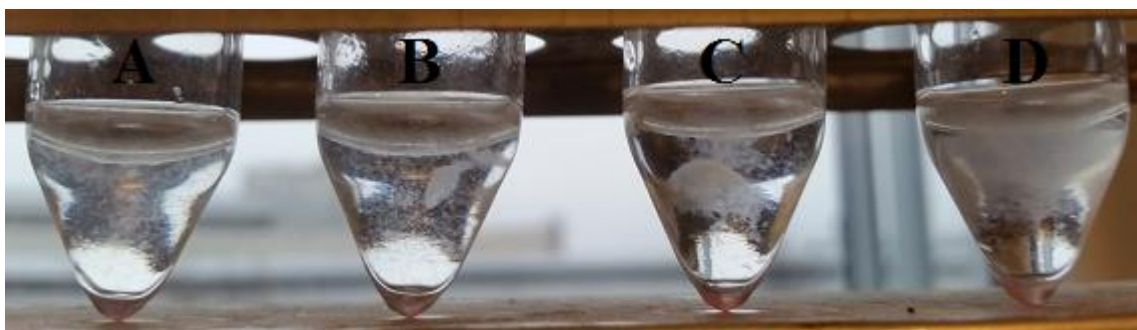
Obrázek 34: Fotografie fázově separovaných systémů hyaluronan-lipid po ovlivnění interakce NaOH o různé koncentraci. A) 50 \text{ mmol} \cdot \text{dm}^{-3} , B) 95 \text{ mmol} \cdot \text{dm}^{-3} , C) 145 \text{ mmol} \cdot \text{dm}^{-3} , D) 375 \text{ mmol} \cdot \text{dm}^{-3} .
