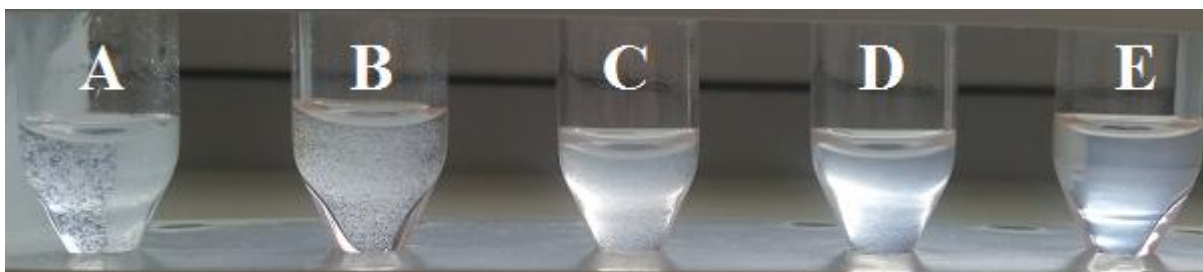
Obrázek 40: Fotografie fázově separovaných systémů chondroitin sulfát-lipid s poměrem 3,2 hmotnostních koncentrací DPTAP/CS s různou koncentrací chloridu sodného. A) 0 \text{ mmol} \cdot \text{dm}^{-3} NaCl, B) 150 \text{ mmol} \cdot \text{dm}^{-3} NaCl, C) 250 \text{ mmol} \cdot \text{dm}^{-3} NaCl, D) 500 \text{ mmol} \cdot \text{dm}^{-3} NaCl, E) 1 \text{ mol} \cdot \text{dm}^{-3} NaCl.
