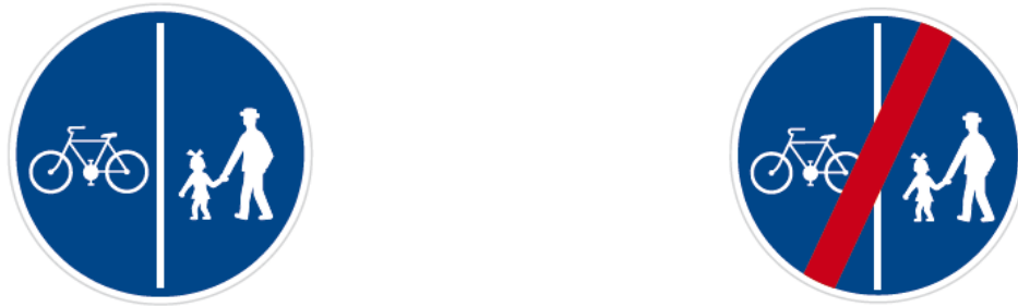
Obr. 3: Dopravní značky č. C 10a – „Stezka pro chodce a cyklisty“ a č. C 10b – „Konec stezky pro chodce a cyklisty“
