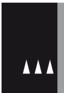
Obr. 9: Dopravní značka č. V 17 – „Trojúhelníky“, značí nájezd na uměle vytvořenou nerovnost
