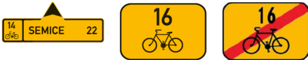
Obr. 6: Dopravní značky č. IS 19a – „Směrová tabule pro cyklisty s jedním cílem“, č. IS 21a – „Směrová tabulka pro cyklisty“ a č. IS 21d – „Konec cyklistické trasy“ Zdroj: BESIP 2013
