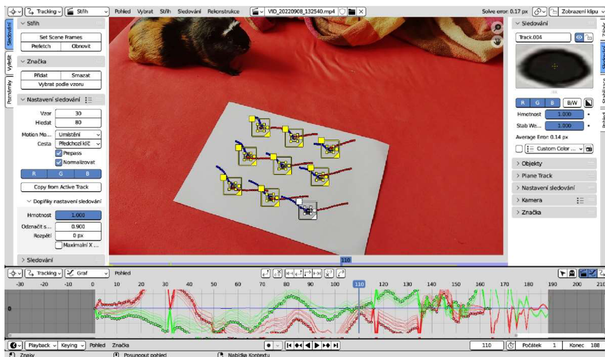
Obrázek 49: Motion tracking (sledování bodů) v Blenderu
