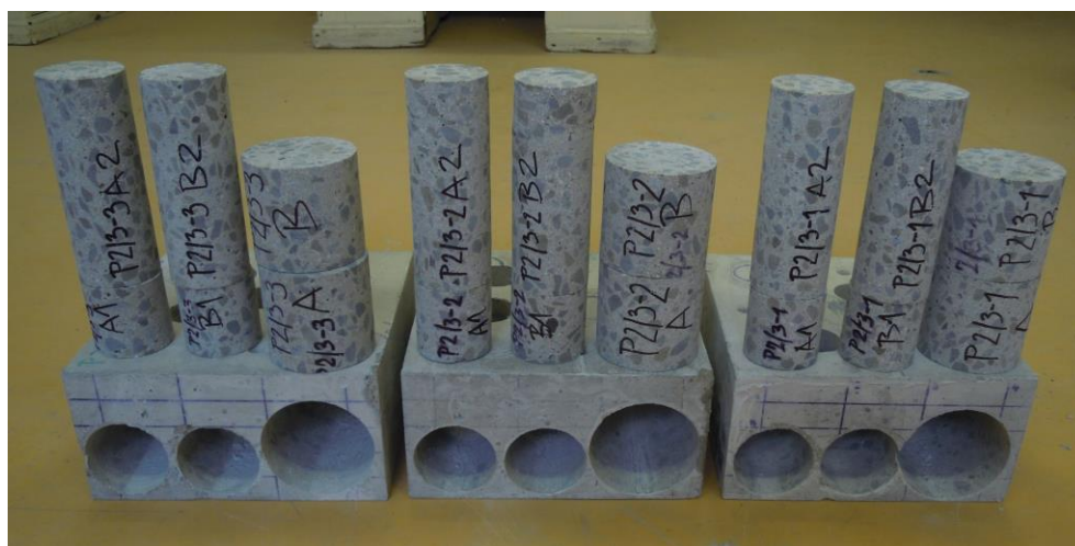
Obr. 14 Jádrové vývrty získané z betonu P2/3
