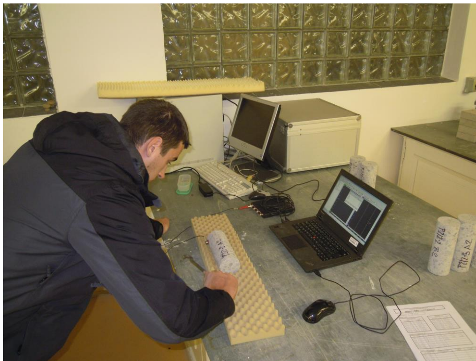
Obr. 18 Ukázka měření vlastní příčné frekvence tělesa
