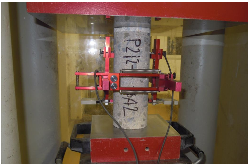
Obr. 17 Vzorek betonu P2/2 osazený měřicím zařízením (tenzometry), které je součástí lisu FORM+TEST 3-3000 ALPHA
