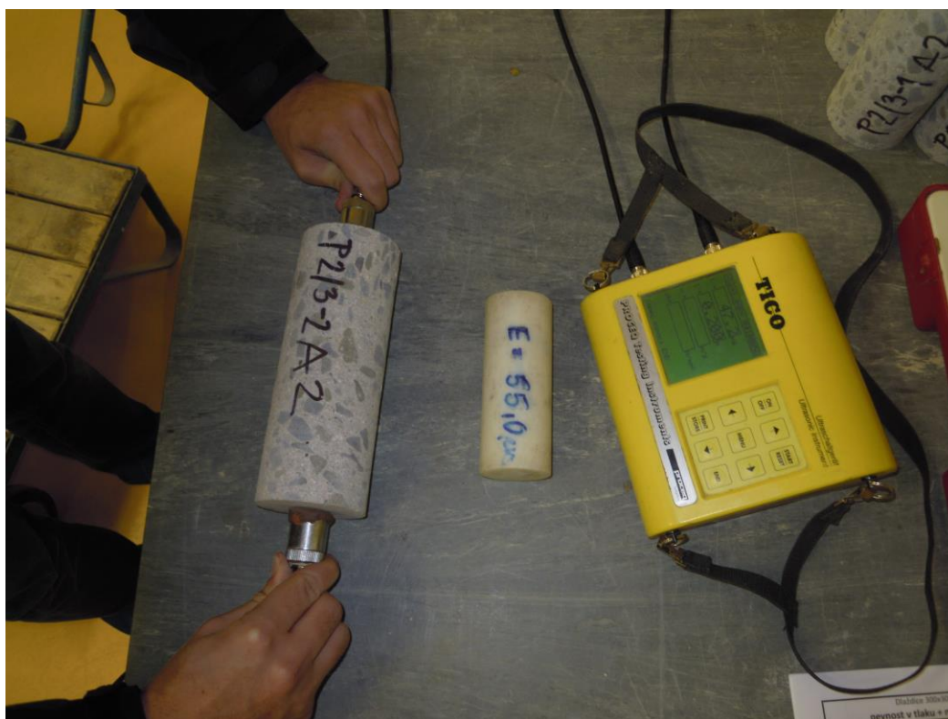
Obr. 19 Měření dynamického modulu pružnosti impulzovou UZ metodou
