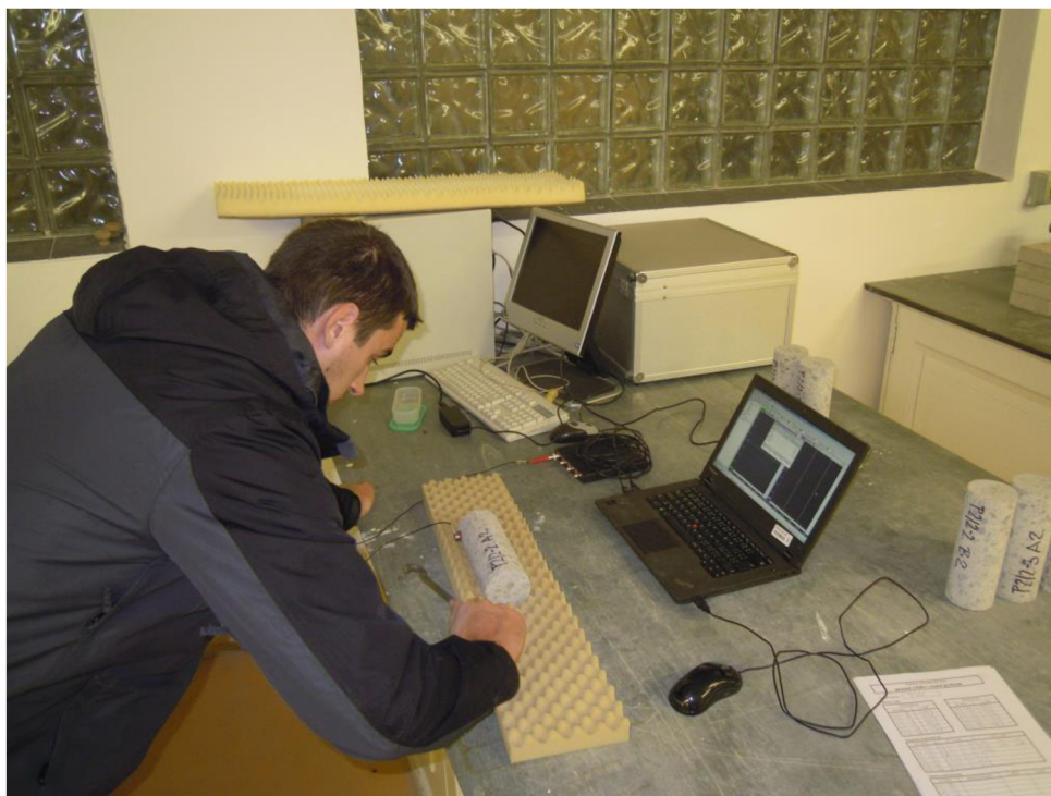
Obr. 18 Ukázka měření vlastní příčné frekvence tělesa
