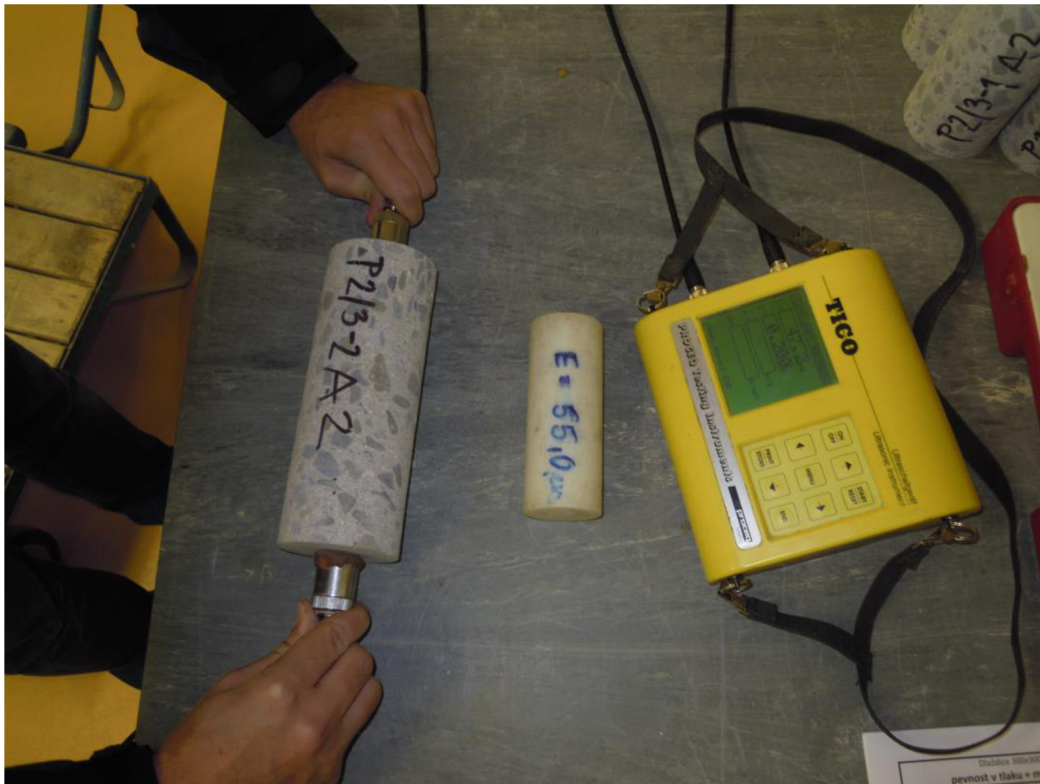
Obr. 19 Měření dynamického modulu pružnosti impulzovou UZ metodou
