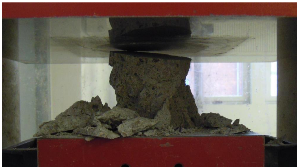
Obr. 16 Ukázka porušení vzorku při zkoušce pevnosti v tlaku
