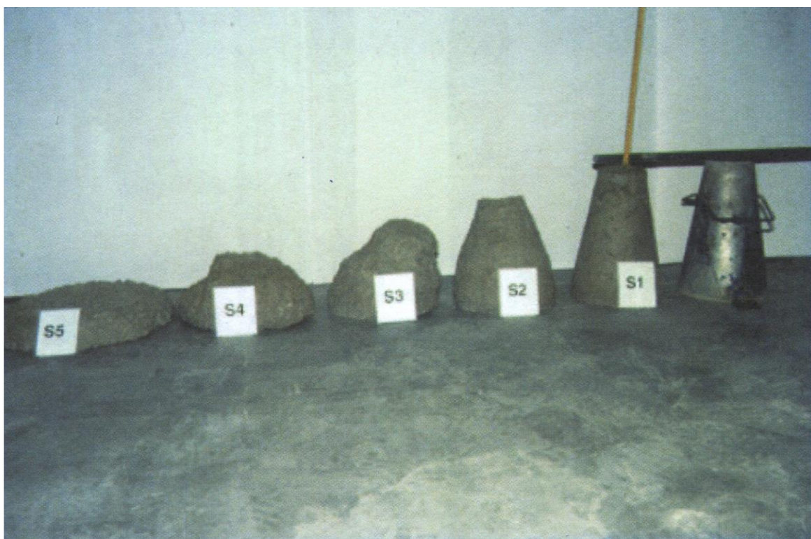
Obr. 2 Sednutí kužele betonu s různou třídou konzistence (od S5 k S1) [2]
