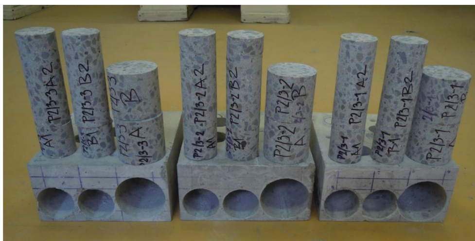
Obr. 14 Jádrové vývrty získané z betonu P2/3
