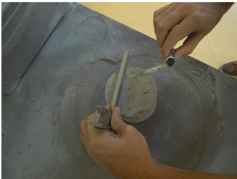
Obr. 15 Úprava dosedacích ploch
