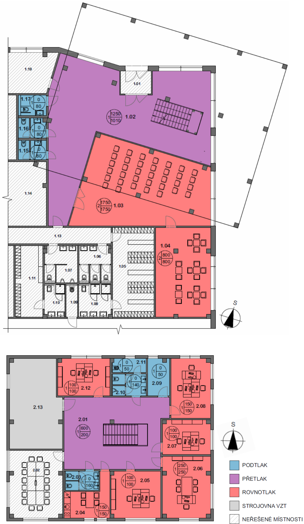
Obr. 23 Tlakové poměry řešených úseků objektu
