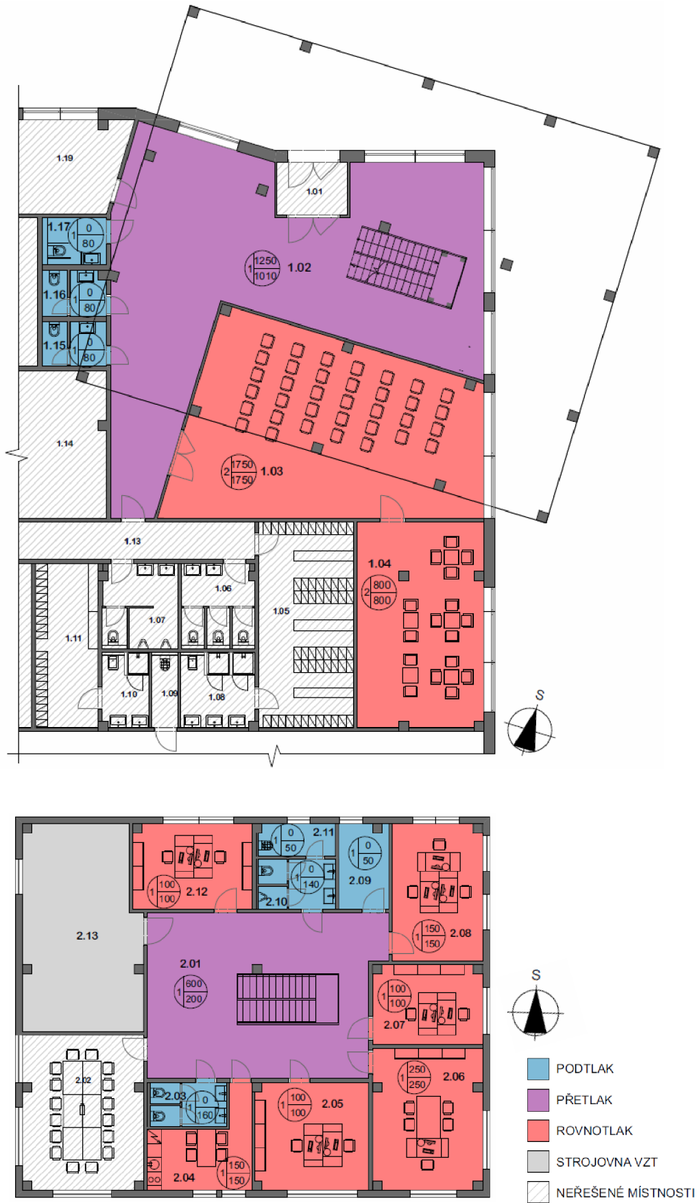
Obr. 23 Tlakové poměry řešených úseků objektu
