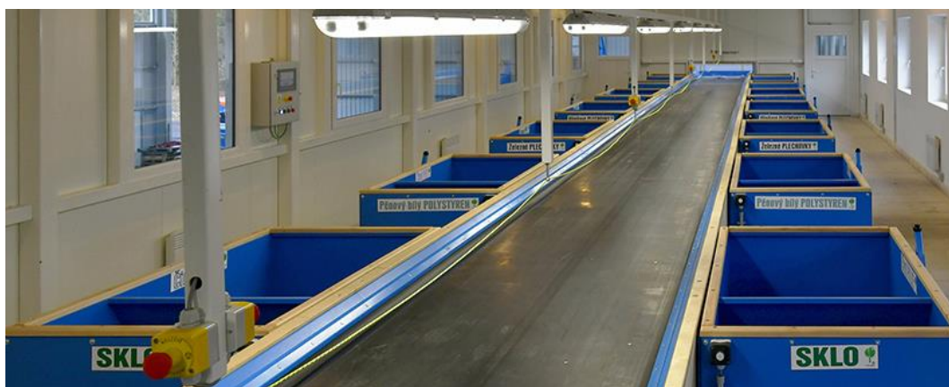
Obr. 25 Pásový dopravník umístěný v kabině ručního třídění [65]
