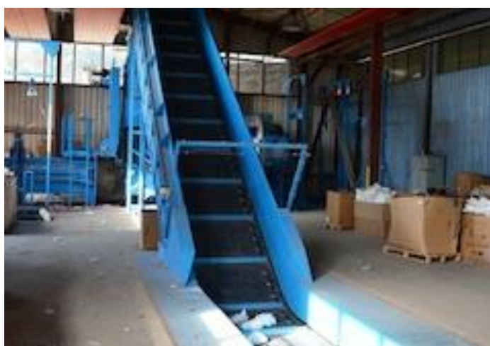
Obr. 24 Řetězopásový dopravník zapuštěný do země [65]
