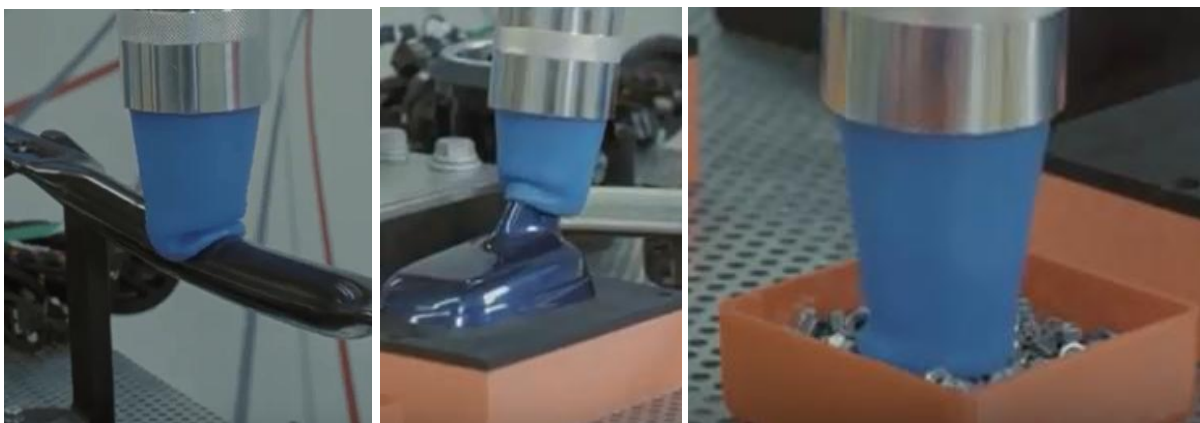
Obr. 11) a) uchopení méně členitých povrchů, b) uchopení součásti členitých tvarů, c) uchopení sypkého materiálu [30]
