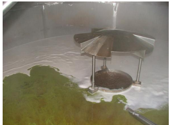
Obr. 24. Chmelovar, mladinová pánev; pivovar C
