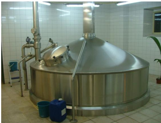
Obr. 22. Rmutovací pánev, celkový pohled a pohled do pánve; pivovar C
