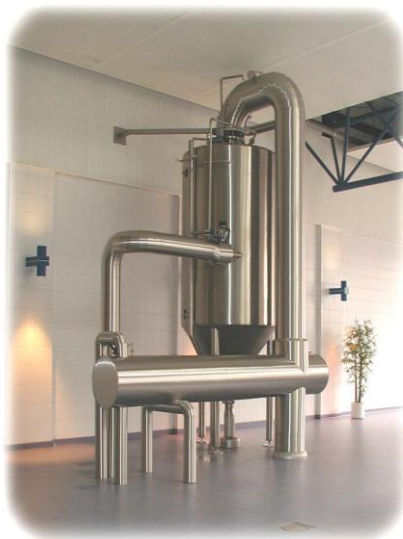
Obr. 8. Zařízení pro podtlakový odpar systém Ziemann
