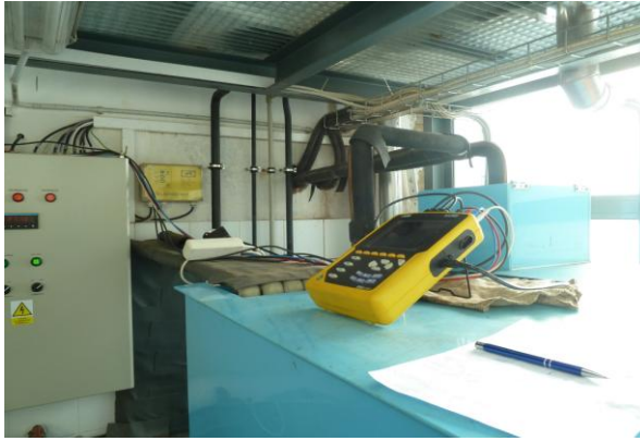
Obr. 12. Zapojení měřicího zařízení CA8332
