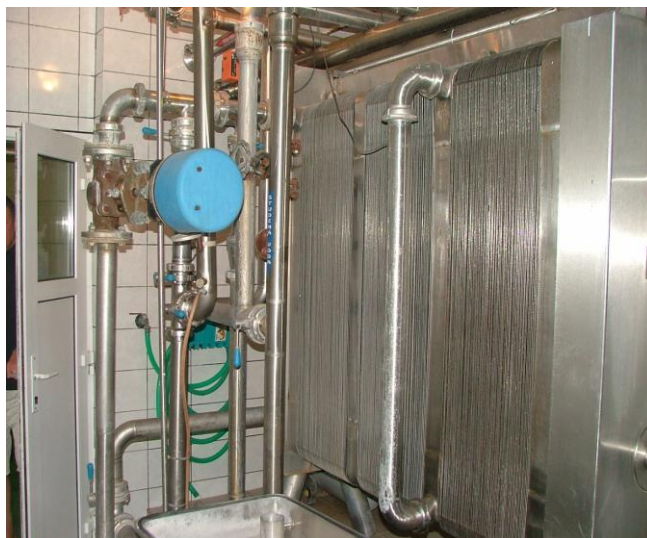
Obr. 25. Chladíč mladiny; pivovar C
