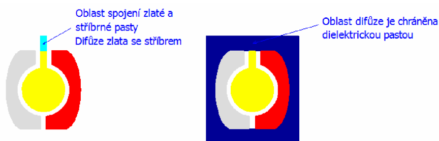
Obr. 7.7: Navržená topologie elektrodového systému.
