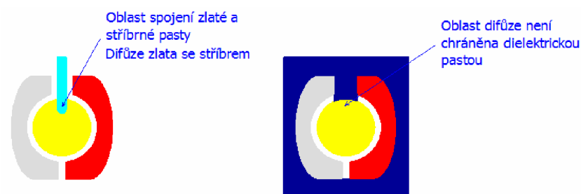
Obr. 7.6: Kruhová topologie pracovní elektrody.
