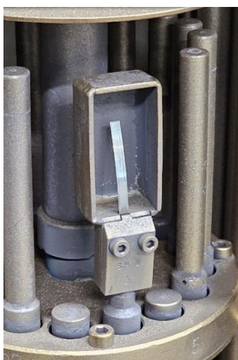
Obr. 14: Uchycení molybdenového pásku při depozici povlaku
