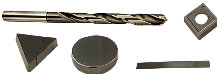
Obr. 8: Použité nástroje a vzorky – Vrták z HSS, řzná destička z HM, vzorek z HM (trojúhelník), vzorek z HSS (kolečko), molybdenový pásek
