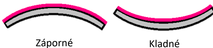
Obr. 13: Prohnutí molybdenového pásku při působení kladného a záporného vnitřního napětí
