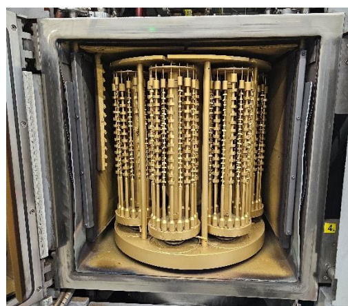
Obr. 2: Rotační držáky pro uchycení povlakovaných nástrojů
