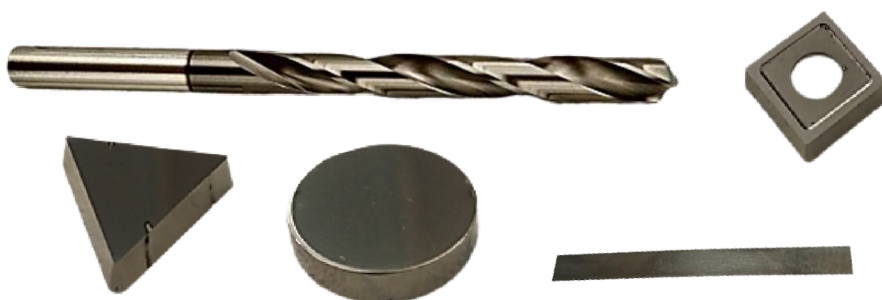
Obr. 8: Použité nástroje a vzorky – Vrták z HSS, řezná destička z HM, vzorek z HM (trojúhelník), vzorek z HSS (kolečko), molybdenový pásek
