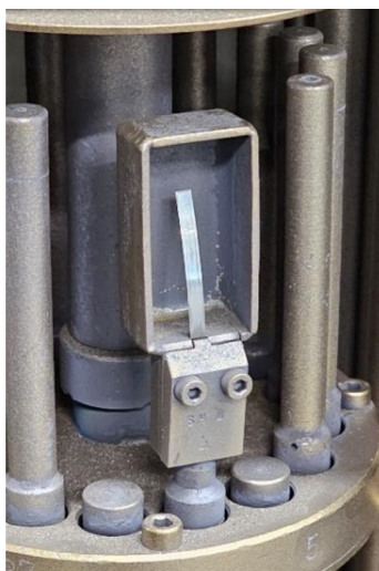
Obr. 14: Uchycení molybdenového pásku při depozici povlaku
