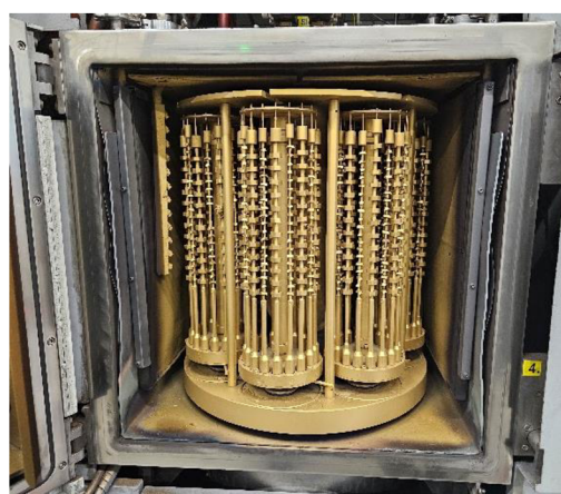
Obr. 2: Rotační držáky pro uchycení povlakovaných nástrojů
