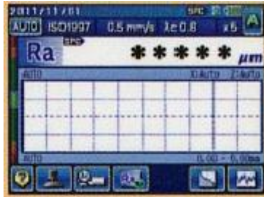
Obrázek 10: Základní obrazovka s protokolem měření na přístroji Mitutoyo SurfTest SJ-410 [13]
