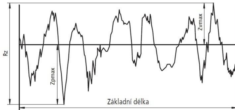
Obrázek 5: Profil povrchu drsnosti pro největší výšku profilu Rz [15]
