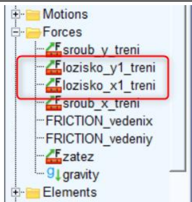
Obr. 32) Reprezentace pasivních odporů v ložiskách pro osu X a Y
