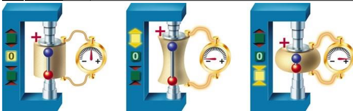
Obr. 5) Princip Piezoelektrického jevu [5]
