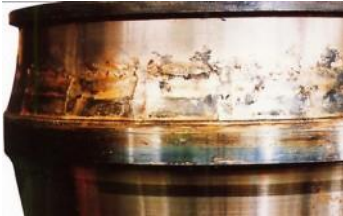
Obr. 9) Degenerace vnitřního kroužku ložiska způsobená nedostatečným mazáním [10]
