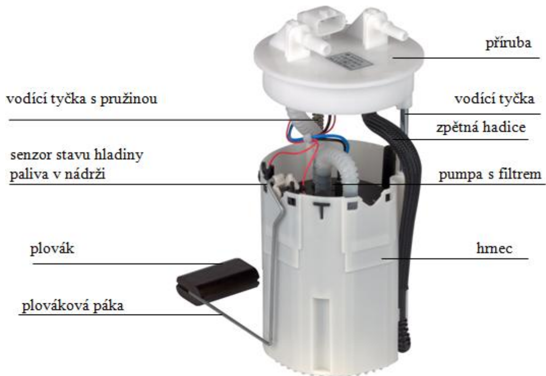
Schéma 8: Nádržový čerpadlový modul
